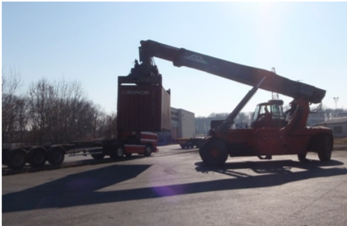
Obrázek 10 Manipulace s kontejnerem pomocí tzv. „reachstackeru“ (ŠKODA AUTO, 2014a)
