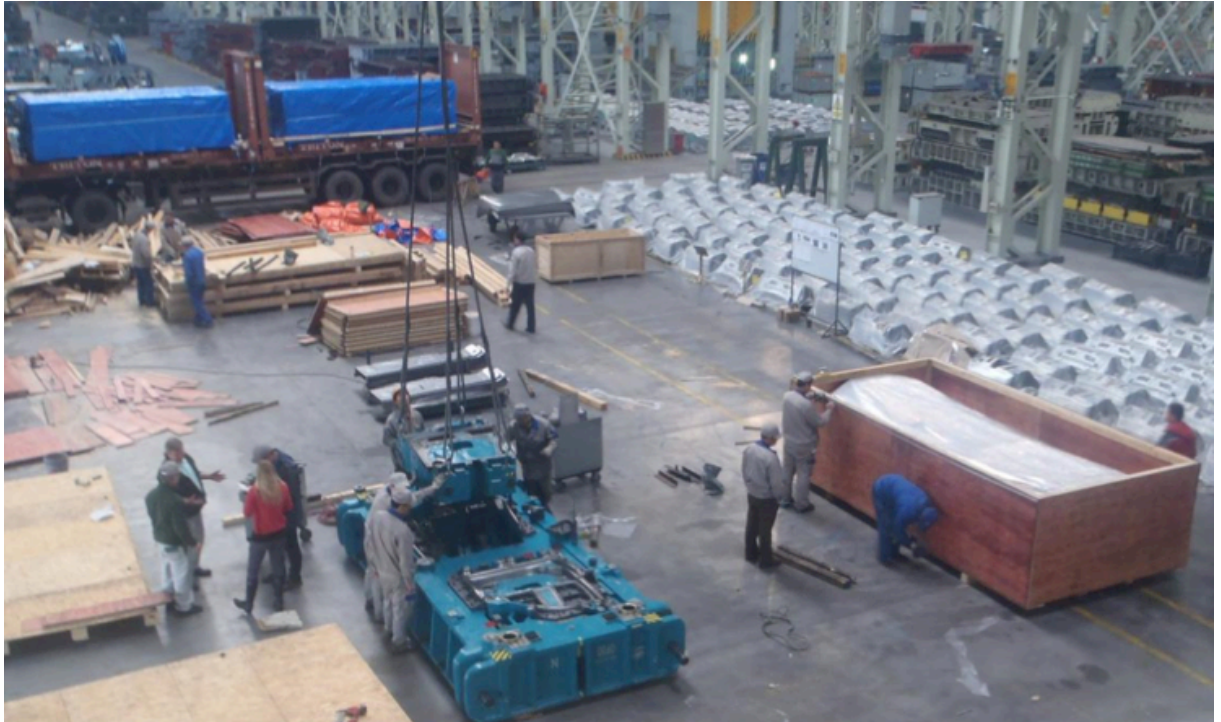
Obrázek 13 Balení lisovacího nářadí pro lodní přepravu za použití přepravní bedny (ŠKODA AUTO, 2014b)
