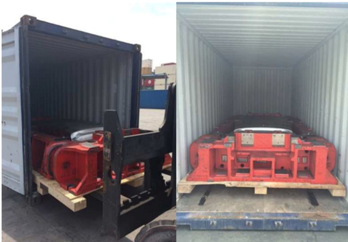
Obrázek 9 Testování naložení lisovacího nářadí do kontejneru (Jašek, 2014)
