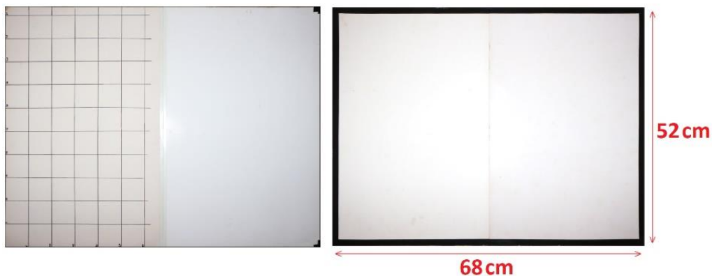
Obrázek 21 - Zkušební pole a kalibrační čtvercová síť, vlastní
