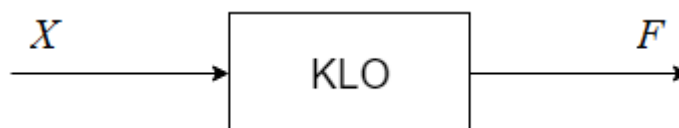
Obr. 2.1 – Kombinační logický obvod jedné proměnné
