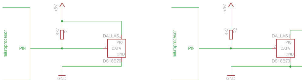
Obr. 2.3 – Zapojení čidla k mikroprocesoru pomocí tří, a dvou vodičového zapojení
