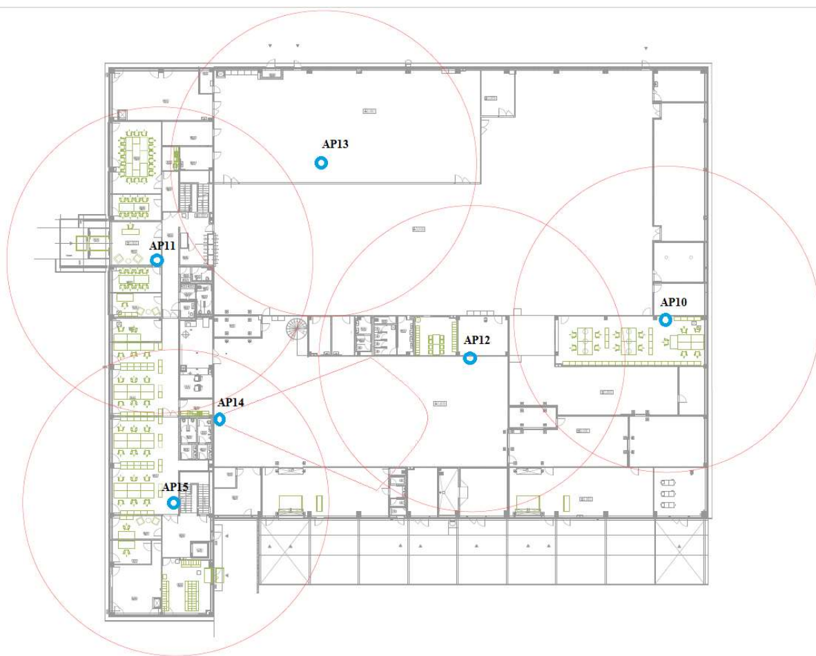
Obrázek 18 – Rozvržení přístupových bodů
