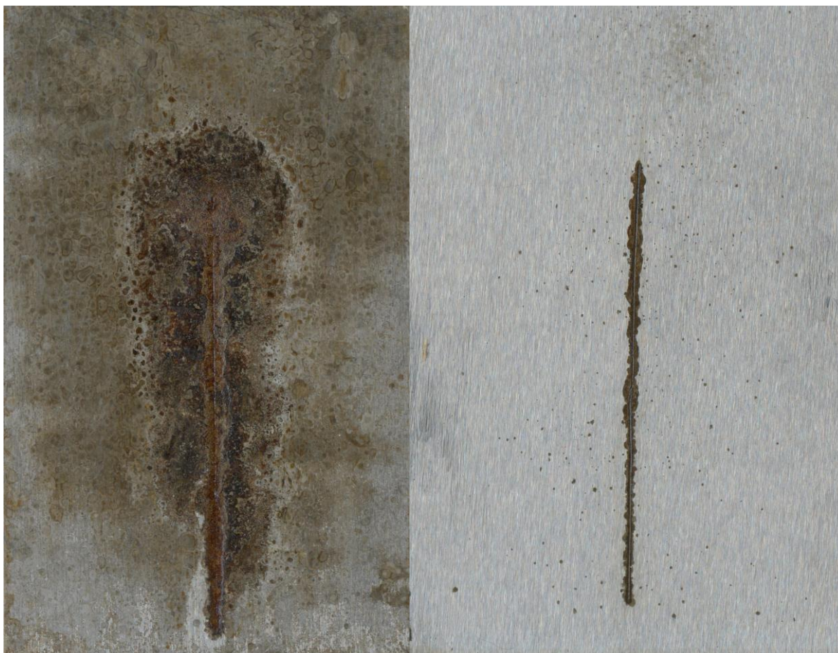
Obr. 36: (vlevo) Koroze v řezu u pigmentu Mg_{0,2}Zn_{0,8}Fe_2O_4 s izometrickými částicemi OKP 10%; (vpravo) Koroze v řezu u pigmentu na bázi směsi oxidů Mg_{0,2}Zn_{0,8}Fe_2O_4/Zn OKP 10%
