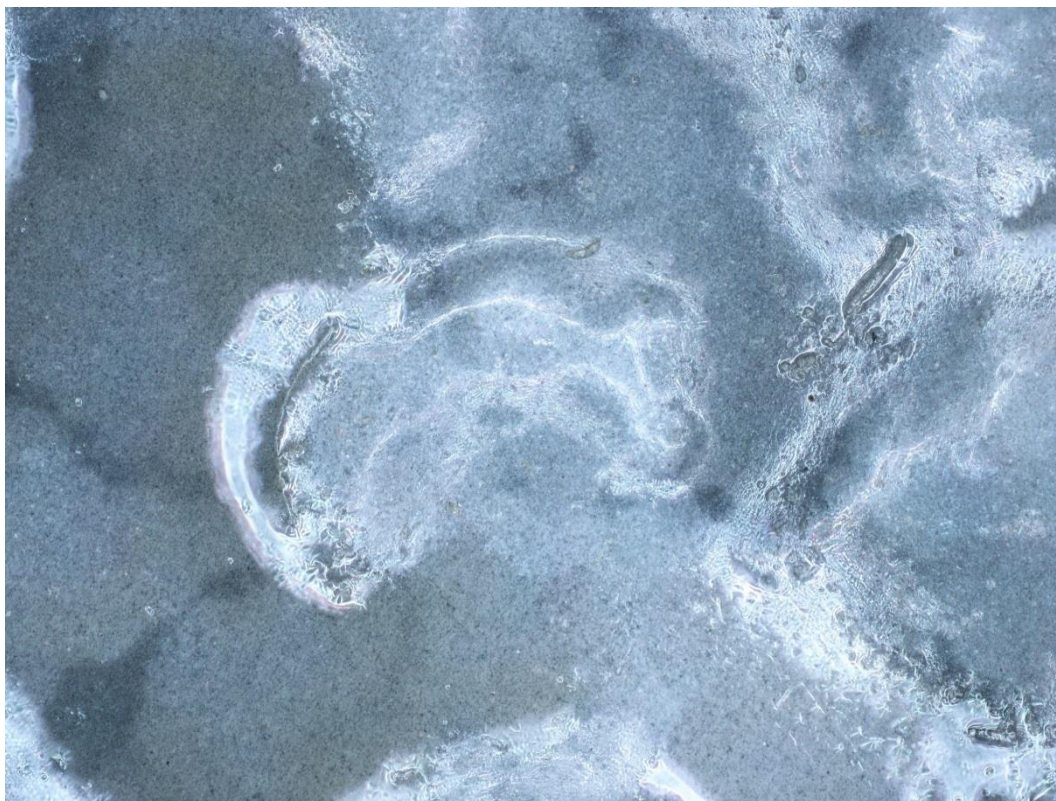
157 - \text{Fe}_3\text{O}_4 , zvětšeno – probíhající změny v odstínu nátěru
