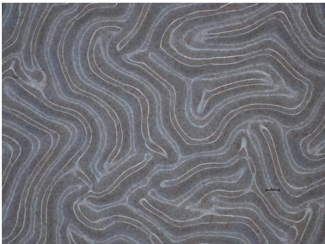
156 - \text{Mg}_{0,2}\text{Zn}_{0,8}\text{Fe}_2\text{O}_4 , zvětšeno – detail zvrásnění viditelného na povrchu nátěru
