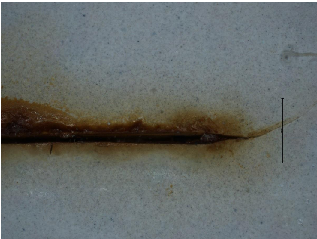
103 - \text{ZnFe}_2\text{O}_4/\text{Zn} , zvětšeno 5x – korozní zplodiny v řezu nátěru
