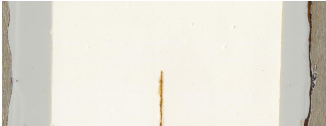
Obr. 35: Změna barvy u pigmentu na bázi směsí oxidů s lamelárními částicemi \text{Mg}_{0,2}\text{Zn}_{0,8}\text{Fe}_2\text{O}_4/\text{Zn} (OKP 15%) po 2100 hodinách expozice
