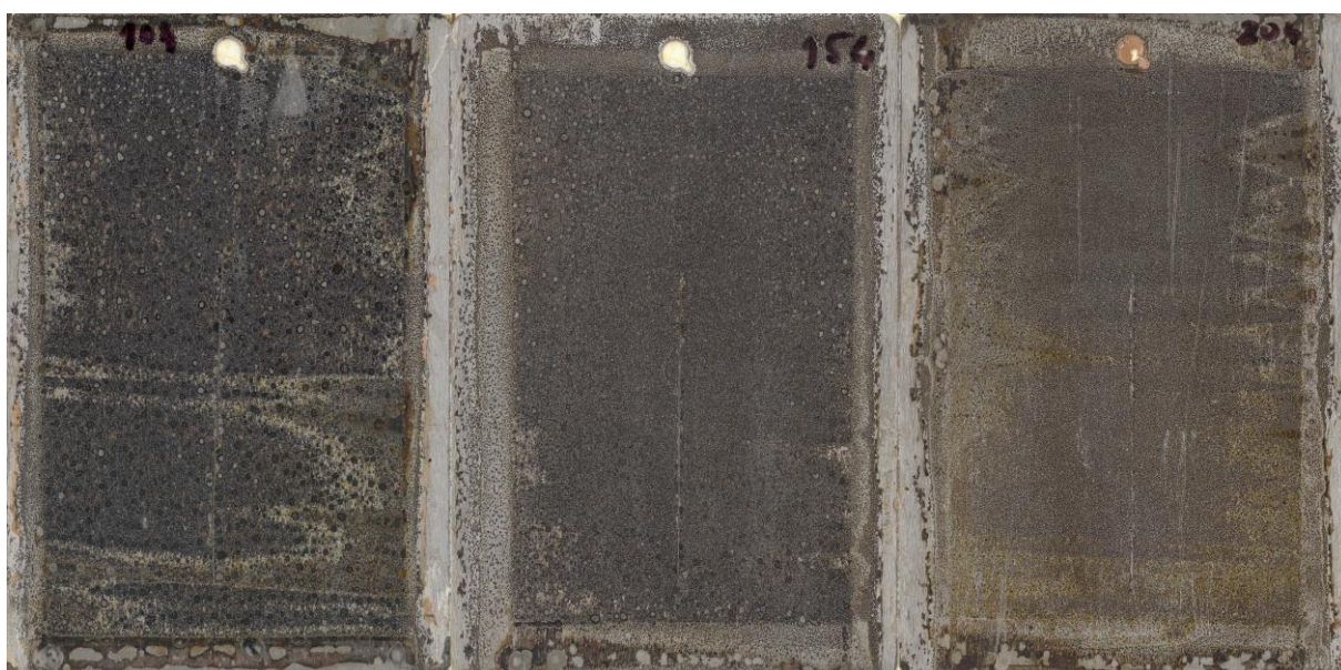
Obr. 34: Příklad rozsahu podkorodování po sejmutí nátěrů s izometrickým feritem ZnFe_2O_4 po 2100 hodinách expozice, OKP A) 10%, B) 15%, C) 20%
