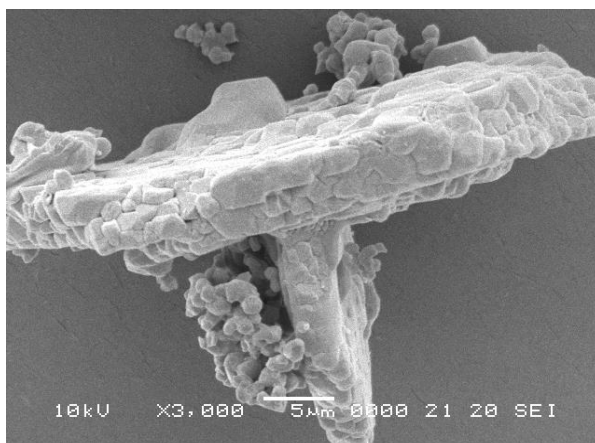
Obr. 3: Snímek jednoduchého lamelárního ferospinelu pořízený elektronovým mikroskopem (Zvětšeno 3000x) 86
