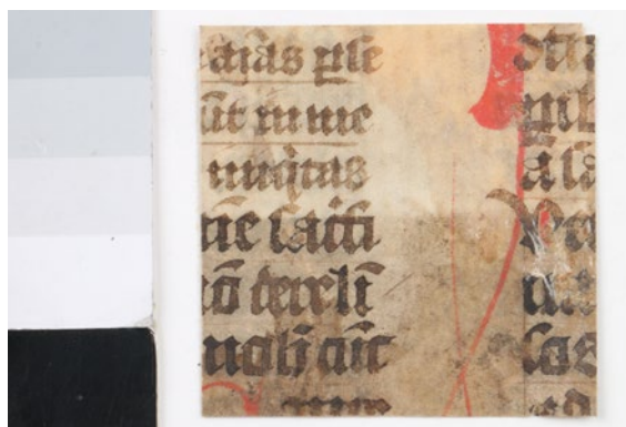
obr. č. 62 – Vzorka hist. písacieho pergamentu MI3, pracovný tlak 2 bar
