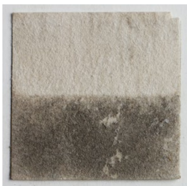
obr. č. 63 – Vzorka MIp4, čistená orechovými škrupinami pri tlaku 3 bar (fotografované v bočnom svetle)
