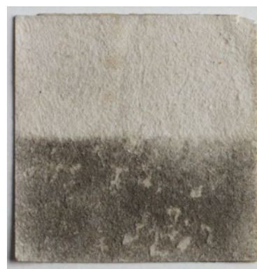
obr. č. 64 – Vzorka MIp5, čistená sklenenou balotinou pri tlaku 3 bar (fotografované v bočnom svetle)
