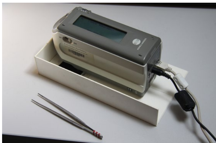
obr. č. 16 – Meranie farebnosti spektrofotometrom
