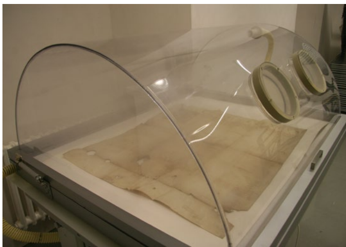
obr. č. 9 – Vlhčenie pergamenovej listiny v klimakomore, foto: autorka textu
