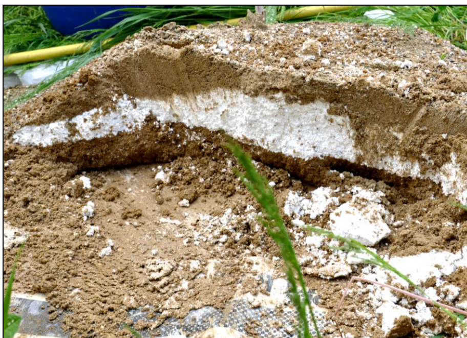
Obrázek 74 – ilustrativní snímek přípravy horké malty vrstvením vápna a písku, tzv. sendvič (pálení vápna v Kartuziánském klášteře v Mauerbachu, workshop 2017).
