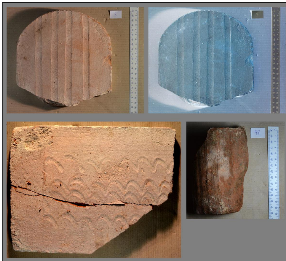
Obrázek 64 – fragmenty střešních krytin. Nahoře spodní část pálené střešní tašky (tzv. bobrovky ) ve tvaru segmentového oblouku s viditelnými žlábkami (svislý směr a vzájemné vzdálenosti naznačují vytvoření lidskými prsty). Vlevo dole vrchní polovina pálené bobrovky s límcem a viditelnou úpravou v podobě vlnek, patrně vytvořených lidskou rukou. Vpravo dole fragment páleného prejzu. Prvky byly použity druhotně, místnost 111/schodiště 1. nadzemní podlaží severního křídla, severní strana místnosti (L. Víšek a D. Zeman, 2015).
