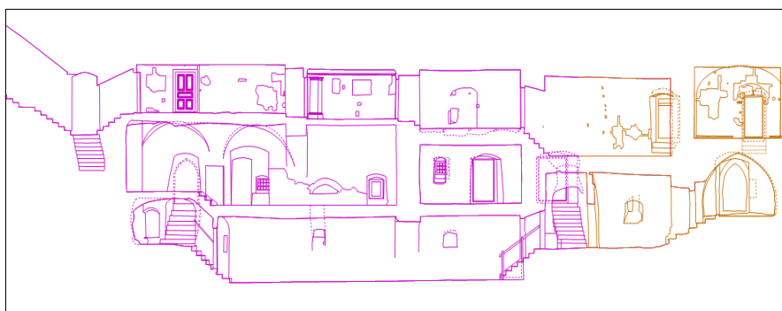
Obrázek 14 - řez mezipatra s lokalizací sond, pohled směrem k východu (zaměření M. Tejkal).
