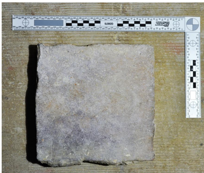
Obrázek 67 – dlažba ze západního otvoru podrobena termoluminiscenční analýze.
