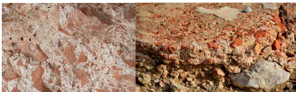
Obrázek 84b – podlahový konstrukční materiál tvořený směsí drcené keramiky v maltové matrici.
