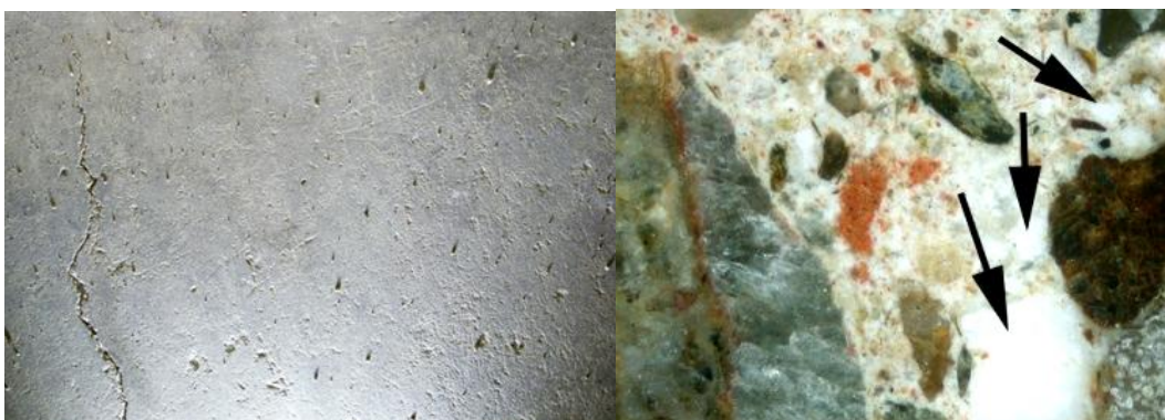
Obrázky 84a – vlevo snímek povrchu podlahy, vpravo mikrosnímek struktury malty v bílém odraženém světle při zvětšení 50x, šipky označují částice nezhomogenizovaného vápna (D. Zeman, K. Bayer, 2007).
