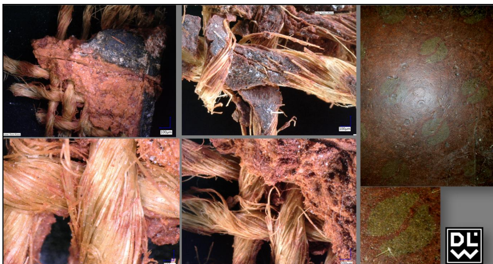
Obrázek 21 – makroskopické snímky přírodního linolea (DLW). Rub s jutovou podložkou a líc s dekorem kávového zrna, Keynce VHX – 900F, zvětšení 100x-200x (D. Zeman).
