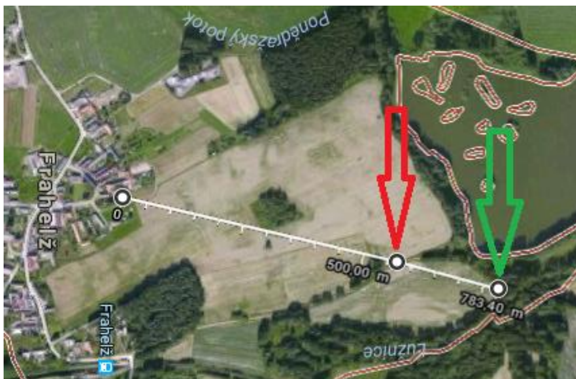
Obrázek 8-11 – Rozmístění stanovišť při kalibračním měření
