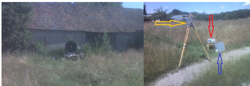
Obrázek 8-9 – Kalibrační měření radaru PCDR35 (radar + navigační radiomaják)
