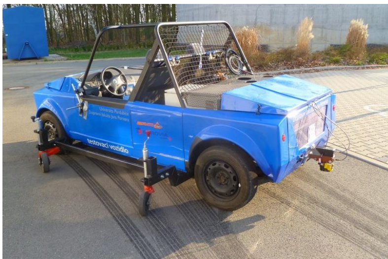
Obrázek 2 Alternativní SkidCar (autor)
