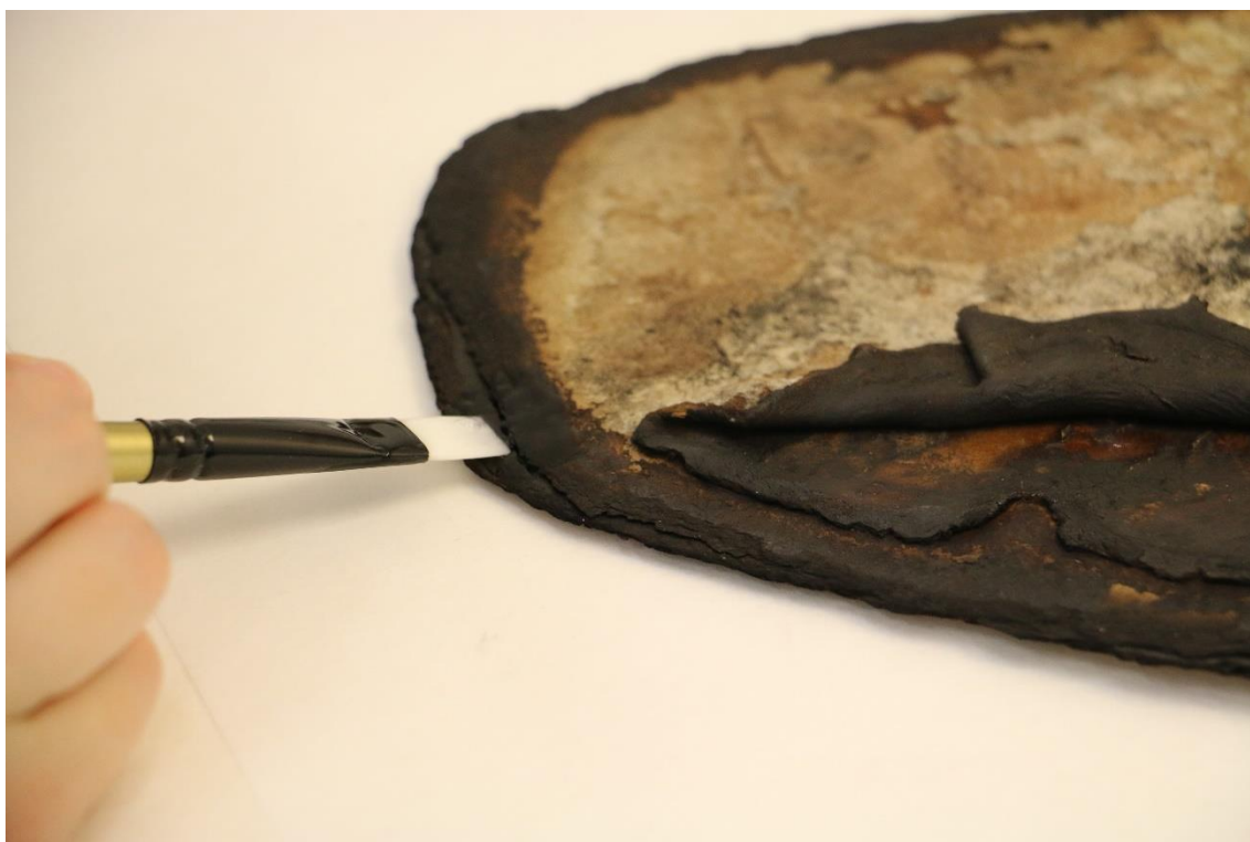
Obrázek 102 Zpevňování ohořelých částí lepenkových desek 1,5 % Tylose MH 300
