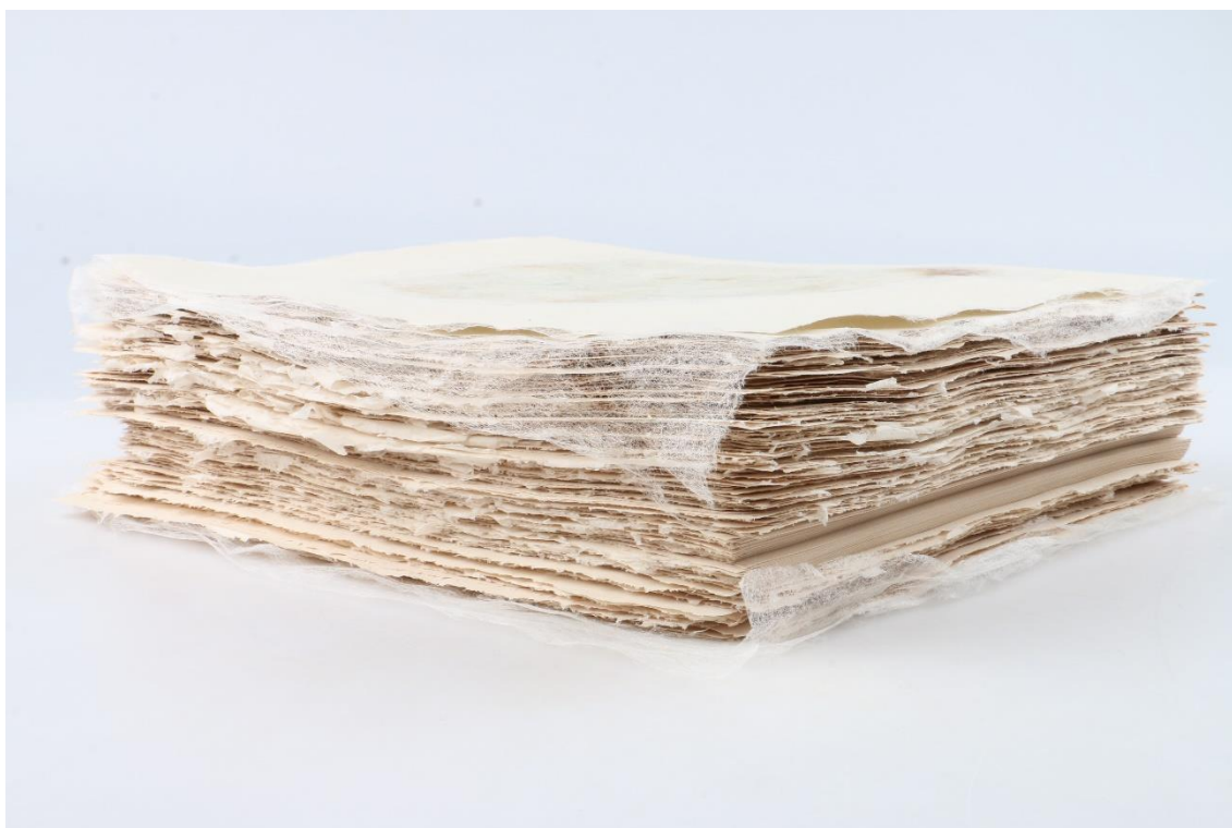
Obrázek 88 Vyspravený knižní blok před ořezáním
