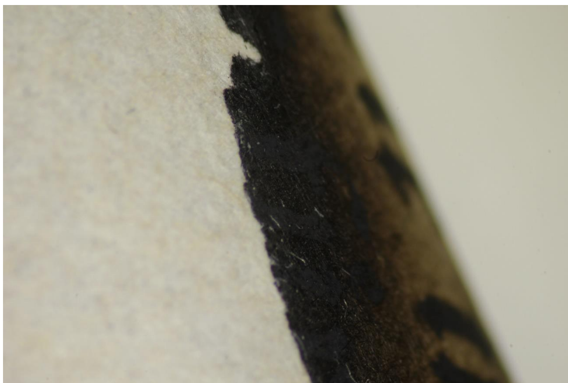
Obrázek 70 Zkouška dolitého doplňku v ohybu z lícové strany (foto stereolupa)
