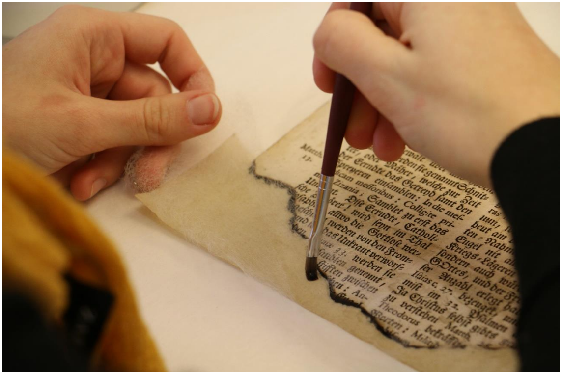
Obrázek 58 Zkouška doplňování ztrát papírové podložky japonským papírem
