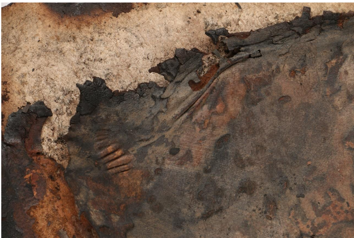
Obrázek 51 Detail zkřehlé a smršťené usně
