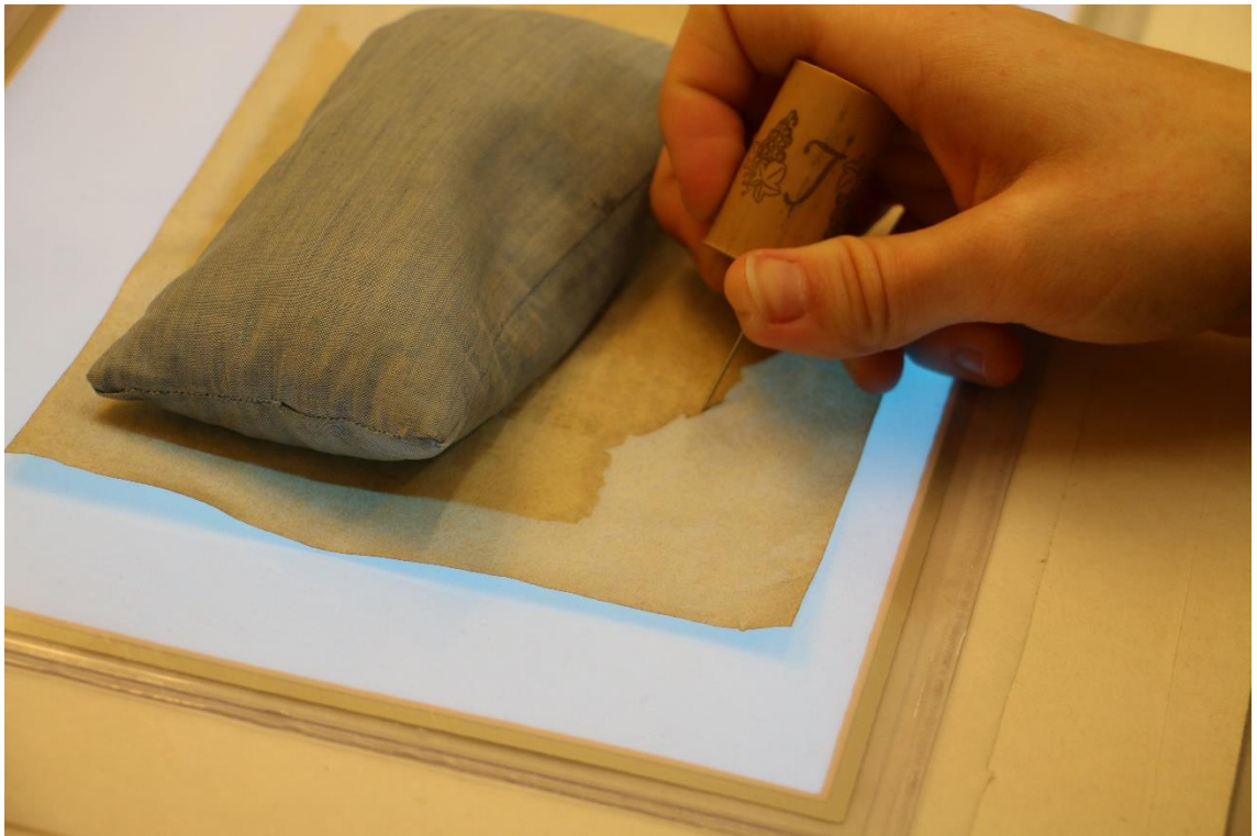
Obrázek 57 Zkouška doplňování ztrát papírové podložky japonským papírem
