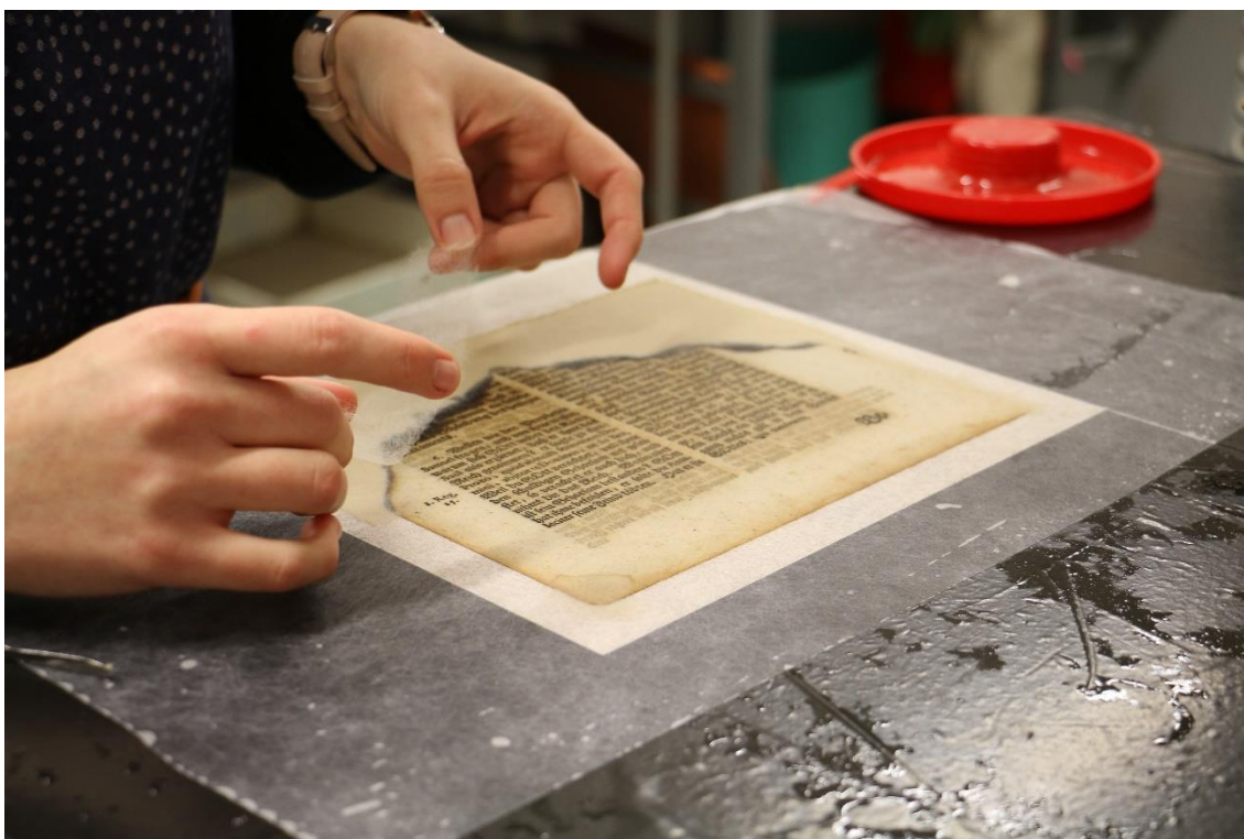
Obrázek 66 Zkouška doplňování ztrát papírové podložky dolitím papírovou suspenzí, zpevnění japonským papírem
