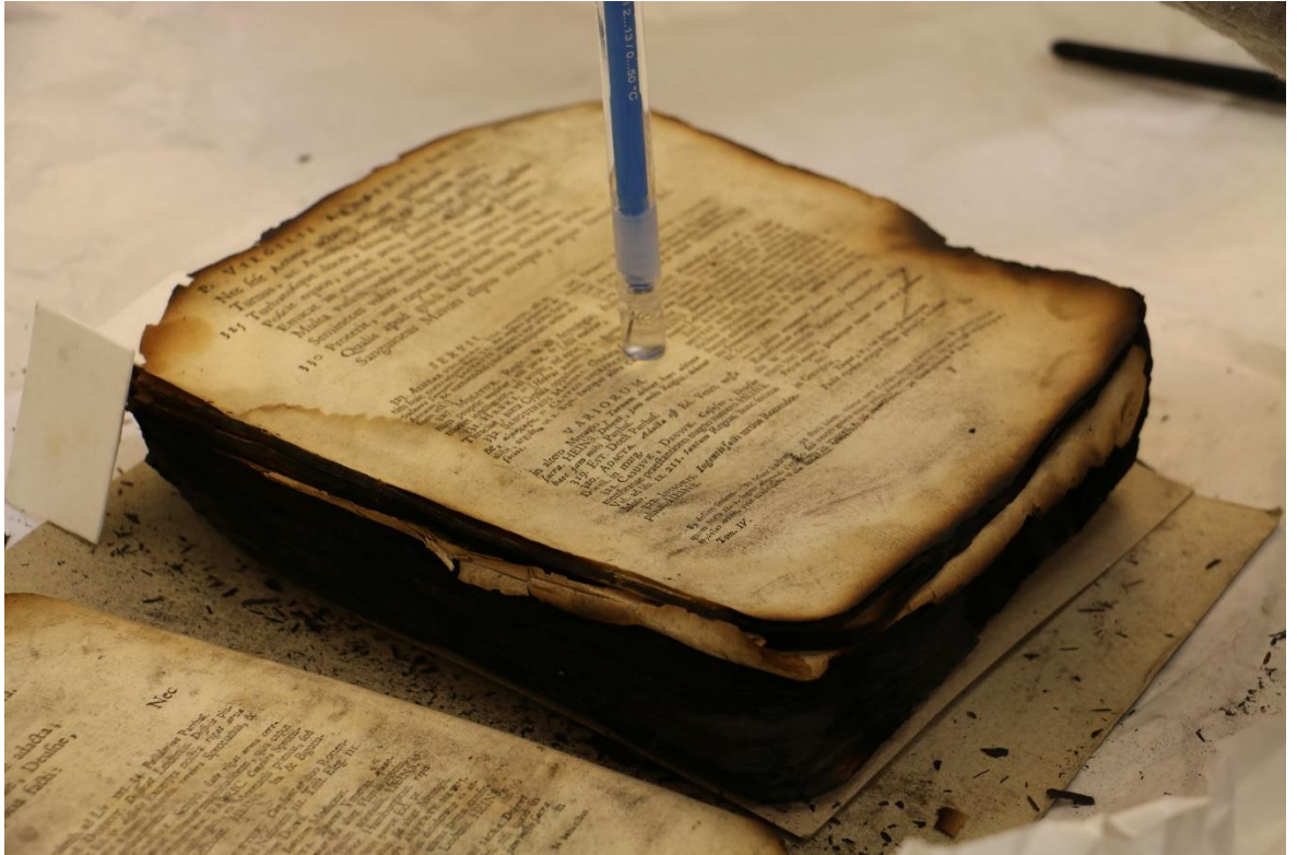
Obrázek 71 Měření pH papírové podložky
