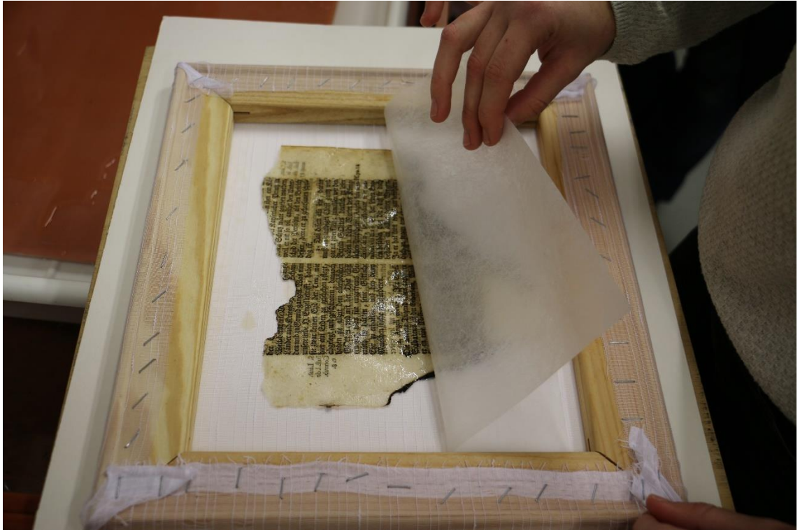
Obrázek 55 Zkouška mokrého čištění na nízké vodní hladině na síťené podložce– zkušební list
