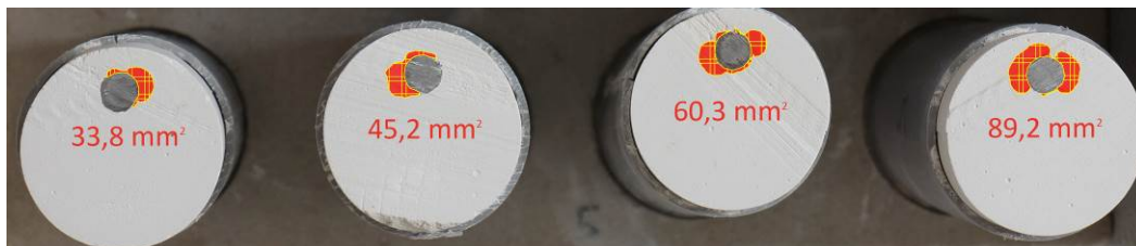
Obrázek 133 Vzorky ošetřené dekanoátem sodným - plocha koroze
