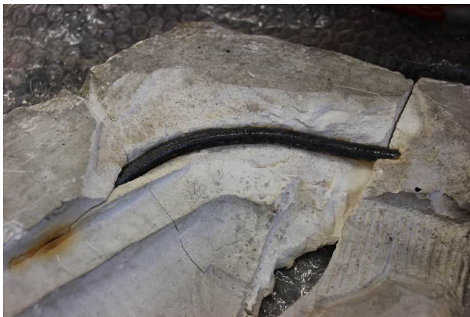
Obrázek 64 Ošetření kovových armatur - po mikroskopování a aplikaci odrezovače na bázi taninu a kyseliny hydrogenfosforečné
