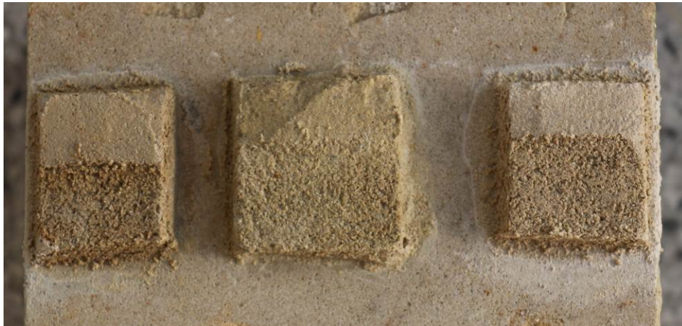
Obrázek 7 Zkouška probarvení směsi pigmenty pro plastickou retuš – zleva – probarvená směs 1 (siena přírodní, révová čern), probarvená směs 2 (zlatý okr světlý, révová čern), neprobarvená směs
