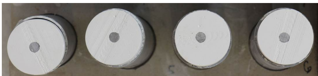
Obrázek 124 Vzorky ošetřené alkytonovým nátěrem - plocha koroze
