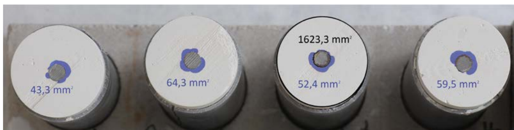
Obrázek 123 Referenční vzorky - plocha koroze, místo řezu M1 a M3. x-vzorek uložený v laboratorních podmínkách, s-vzorek po urychleném stárnutí (zleva).
