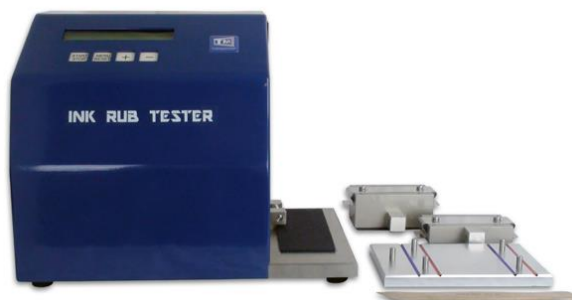
Obrázek 5. Ink Rub tester s příslušenstvím [19]
