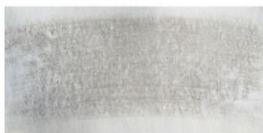
Obrázek 7. Oděrové stopy pro dřevitý papír, kostní čern [zdroj: autorka]
