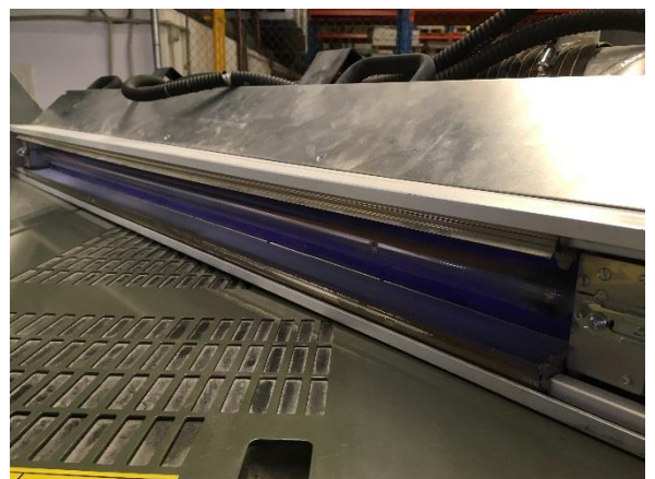
Obrázek 8 – Fotografie (vlevo) celého zdroje UV záření (modulu) v H-UV tiskovém stroji tiskárny H.R.G., fotografie (vpravo) dopované středotlaké rtuťové výbojky v H-UV tiskovém stroji tiskárny H.R.G.
