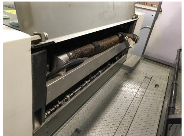
Obrázek 7 – Fotografie (vlevo) umístění zdroje UV záření v H-UV tiskovém stroji tiskárny H.R.G. (v druhé pozici), fotografie (vpravo) umístění zdroje UV záření v H-UV tiskovém stroji tiskárny H.R.G. (v druhé pozici) - detail
