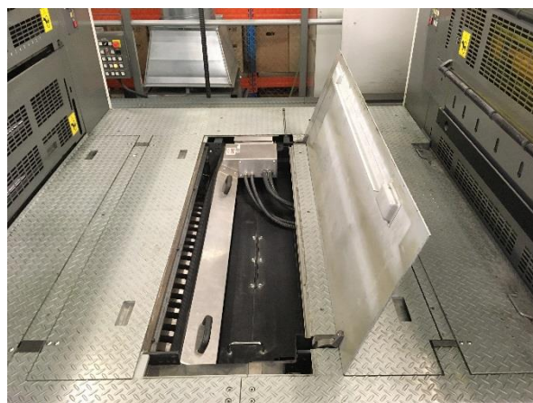
Obrázek 6 – Fotografie (vlevo) umístění zdroje UV záření v H-UV tiskovém stroji tiskárny H.R.G. (v první pozici), fotografie (vpravo) umístění zdroje UV záření v H-UV tiskovém stroji tiskárny H.R.G. (v první pozici) - detail
