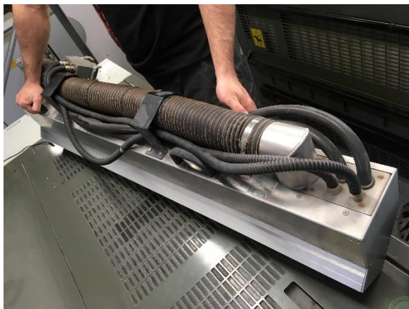
Obrázek 8 – Fotografie (vlevo) celého zdroje UV záření (modulu) v H-UV tiskovém stroji tiskárny H.R.G., fotografie (vpravo) dopované středotlaké rtuťové výbojky v H-UV tiskovém stroji tiskárny H.R.G.
