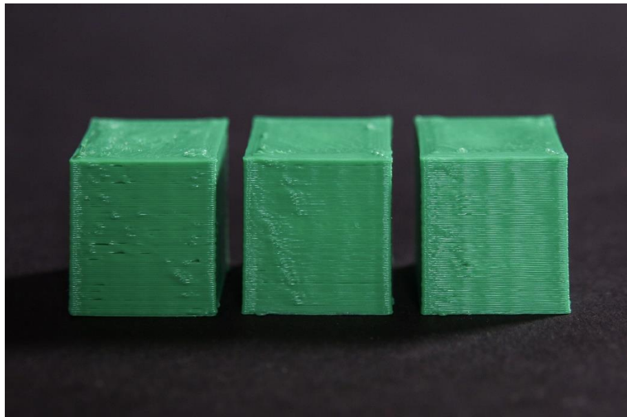
Obrázek 27 Nastavení retrakce materiálu v extruderu. Vlevo bez retrakce, uprostřed s retrakcí 0,5 mm, vpravo s retrakcí 0,9 mm
