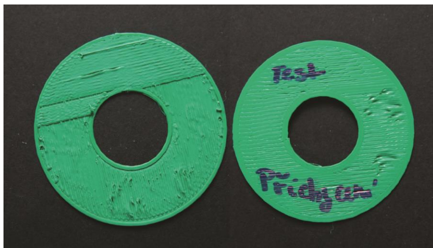
Obrázek 18 Znáornění nesprávného nastavení pozice osy Z horkého konce trysky. Vlevo vrchní část objektu, vpravo plocha přiléhající ke sklu
