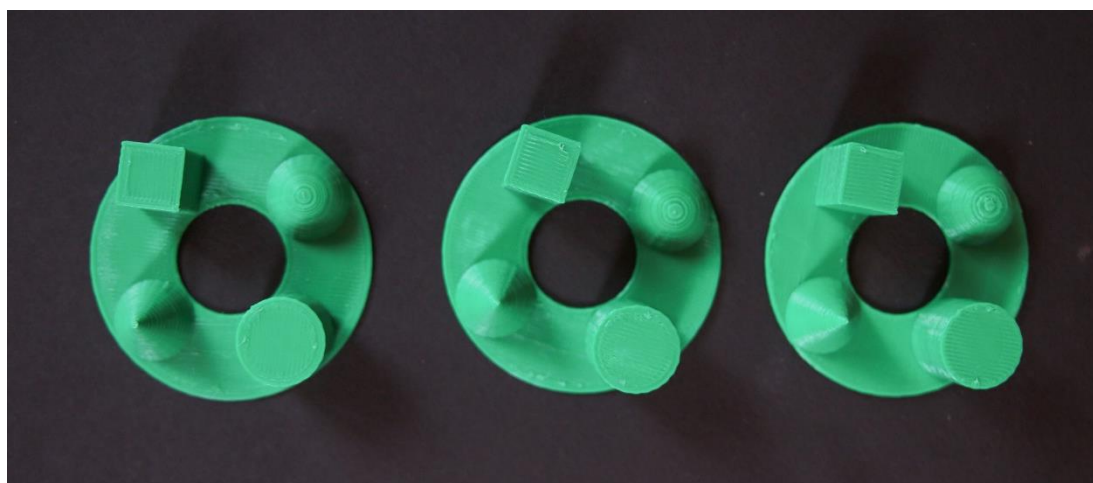
Obrázek 55 Porovnání testovacích komplexů tištěných materiálem PLA. Zleva kvalitní mód, uprostřed střední mód, vpravo rychlý mód
