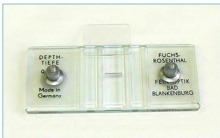
Obr. 15: Fuchsova-Rosenthalova komůrka pro vyšetření počtu jaderných elementů a erytrocytů v hrudním výpotku
