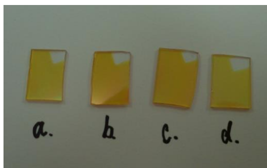
Obr. 66. Fotografie vzorků tenkých vrstev připravených metodou PLD; a – Ge_{34,5}S_{65,5} , b – Ge_{33}Ga_2S_{65} , c – Ge_{31}Ga_4S_{65} , d – Ge_{28}Ga_{6,5}S_{65,5} ;
