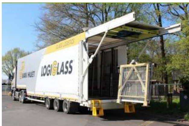
Obrázek 2 Vůz pro prevoz nebaleného skla, zdroj [online 4].
