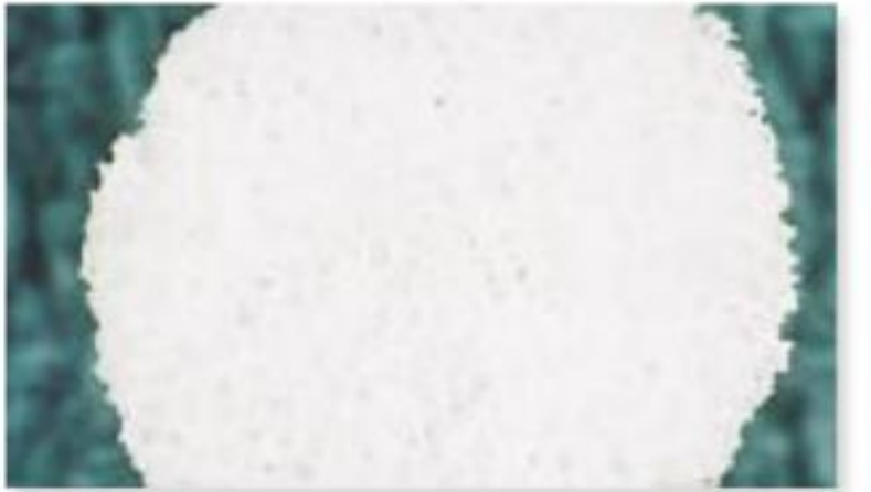
Obrázok 14.: Biokeramický orbitálny implantát tvorený Al 2 O 3 . [34]
