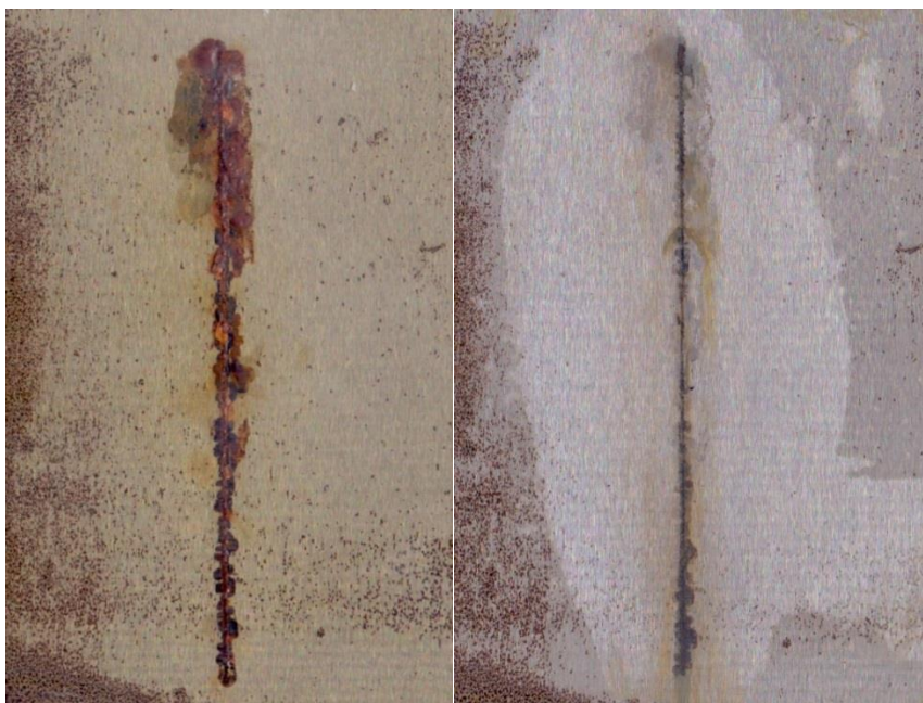
Obrázek 24: Alkydová pryskyřice po zrychlené korozní cyklické zkoušce
