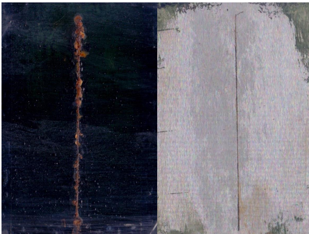
Obrázek 36: Mastek/PANI OKP 5 % po zrychlené korozní cyklické zkoušce
