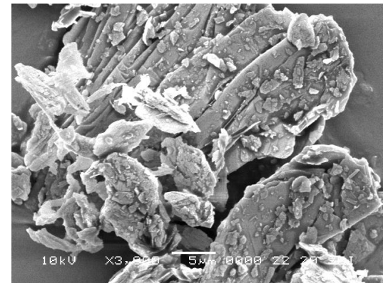
Obrázek 16: Částice Mastku s povrchovou úpravou zinkferitu z elektronického mikroskopu, zvětšeno 1000x (vlevo)
