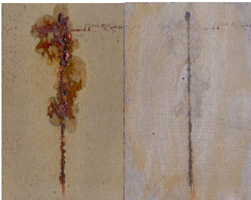
Obrázek 25: Kaolín/Si OKP 5 % po zrychlené korozní cyklické zkoušce
