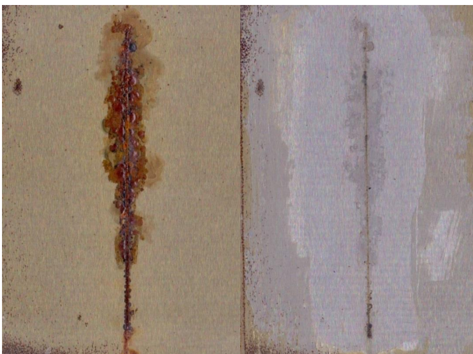
Obrázek 26: Kaolín/Si OKP 15 % po zrychlené korozní cyklické zkoušce
