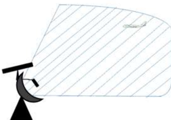
Obrázek 4.10 - Skenování prostoru pomocí průběhu kosekanty
