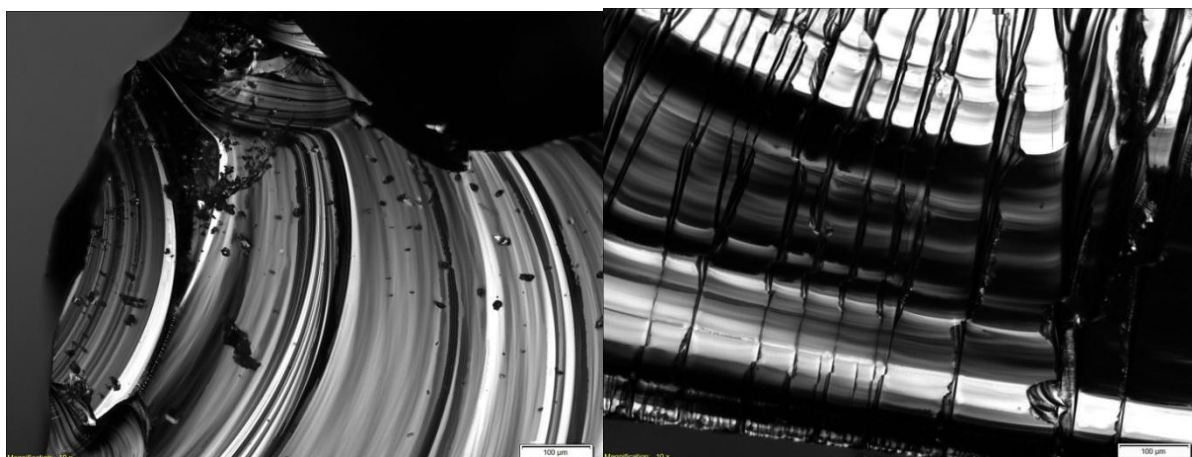
Obr. P-11: Snímky amorfního As_2Se_3 získané pomocí infračerveného optického mikroskopu
