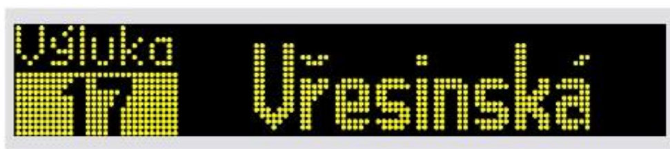
Obr. 4 Označení čelního panelu linky dotčené výlukou
