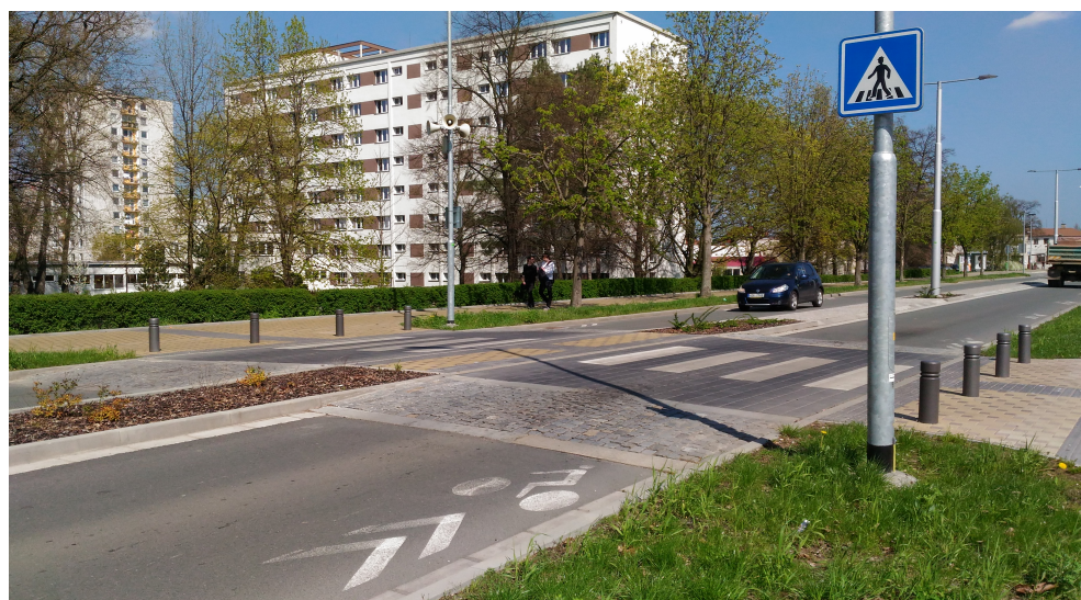
Obr. 7: Přechod pro chodce se zpomalovacím příčným prahem
