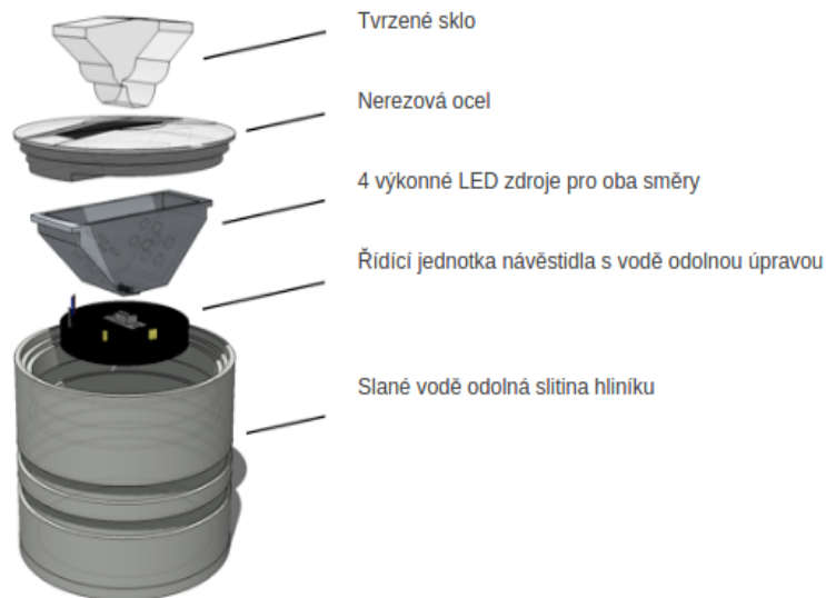
Obr. 26: Konstrukce zemního LED návěstidla PDS-400
