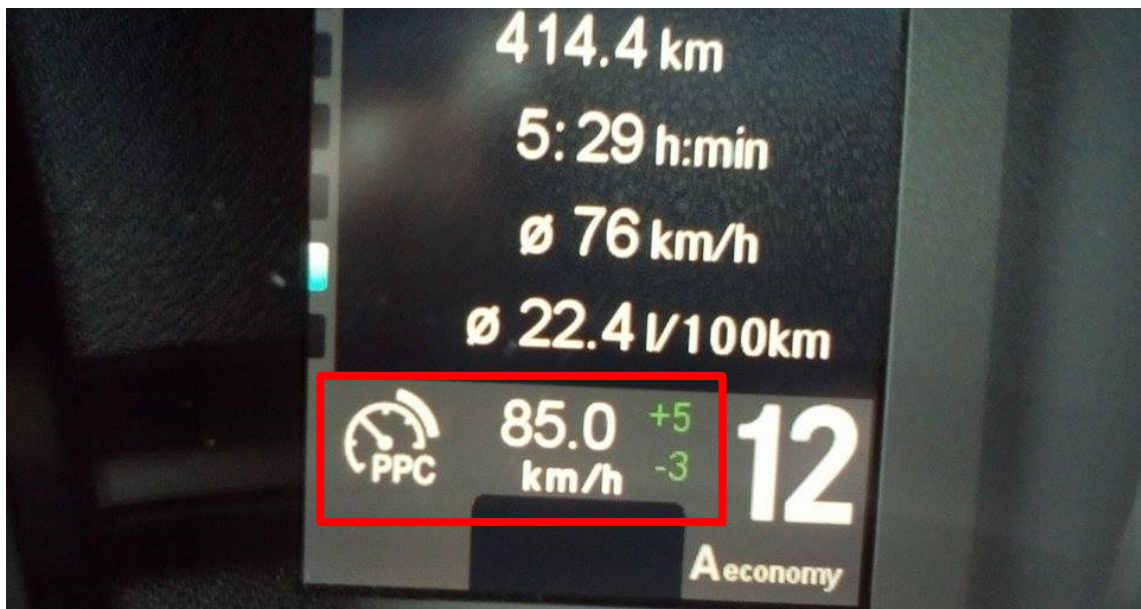
Obrázek 12 Nastavení systému PPC na palubním počítači (Mercedes-Benz Actros)
