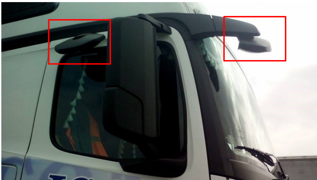
Obrázek 10 Zrcátka minimalizující mrtvý úhel tahače Mercedes-Benz Actros
