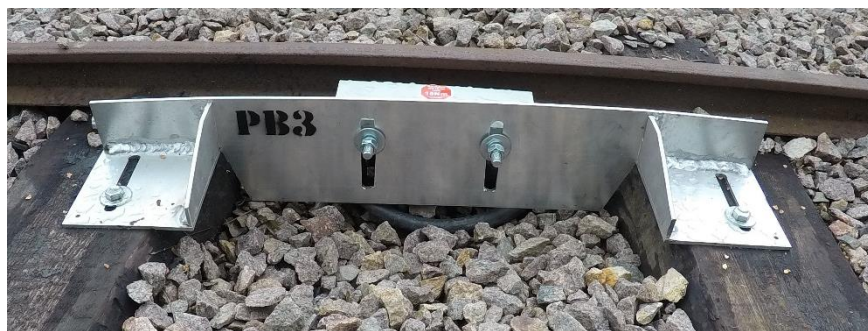
Obrázek 4-8 Ukázka instalace atypického přípravku s RSR180
