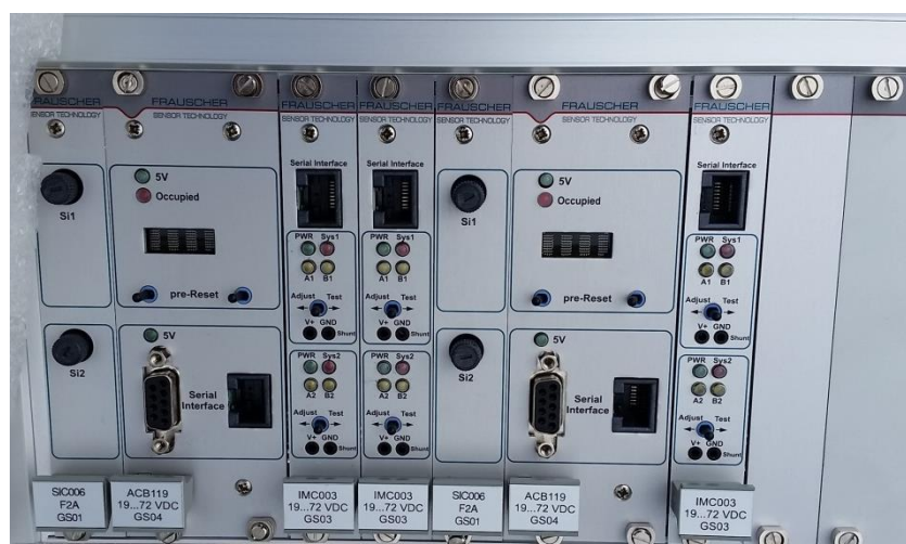
Obrázek 4-2 Kazeta počítače náprav použitého na VVCD
