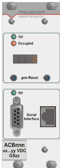
Obr. 2.2.: Pohled na čelní panel čítačové jednotky ACB
