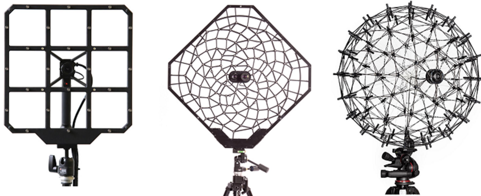
Obr. 16: Další méně běžné verze mikrofonního pole – čtvercová konfigurace, speciální pole (120 mikrofonů a dvě kamery) a sférické prostorové mikrofonní pole.
