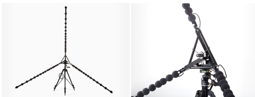
Obr. 15: Akustická kamera hvězdicové topologie Star 48 AC Pro – celek a detail středu s kamerou (zdroj: acoustic-camera.com).
