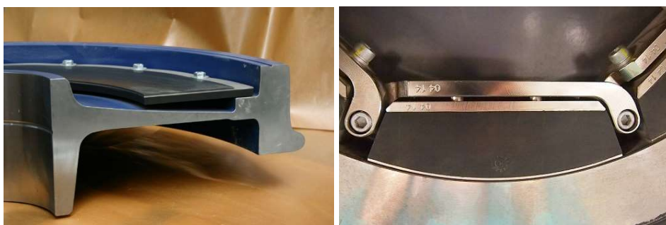
Obr. 28: Fotografie provedení kolových hlukových absorbérů GHH-BONATRANS – deskový absorbér a multisegmentový absorbér (zdroj: ghh-bonatrans.com).
