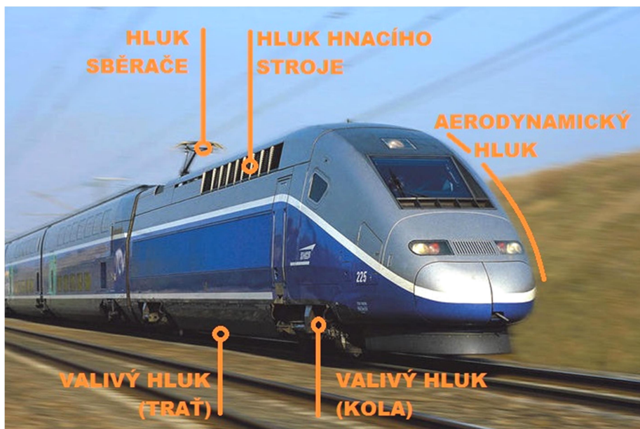
Obr. 4: Hlavní zdroje hluku v železniční dopravě (zdroj: Eurail.com + úpravy).
