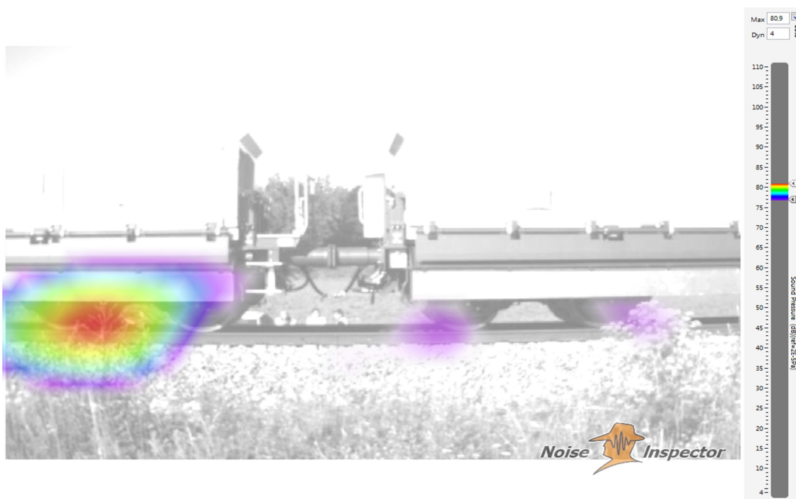
Obr. 25: Vizualizace zdroje hluku při průjezdu soupravy rychlostí 80 km/h, zobrazeno časové okno délky 1,004 s (3,472-4,476 s). Kmitočtové pásmo šířky 40 Hz (1612 Hz-1662 Hz). Příspěvky hluku jsou v hladinách akustického tlaku v rozmezí cca 77-81 dB(A). Zpracováno v SW Noise Inspector.
