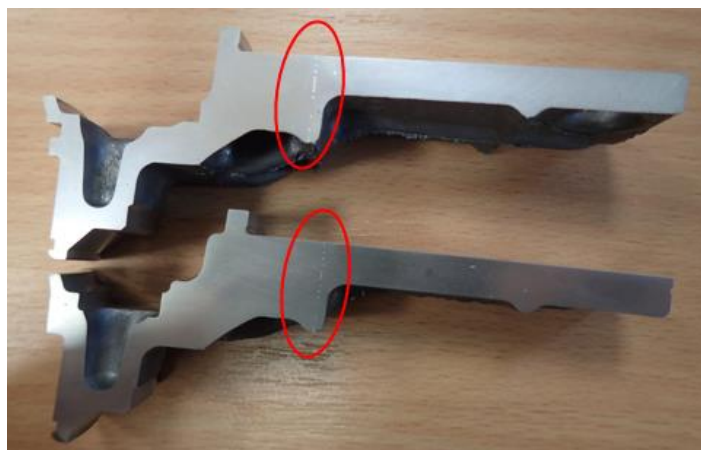
Obr. 57 Místo měření mikrotvrdosti
