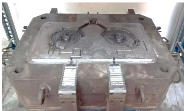
Obr. 42 Tlaková licí forma odlitku 1733-00
