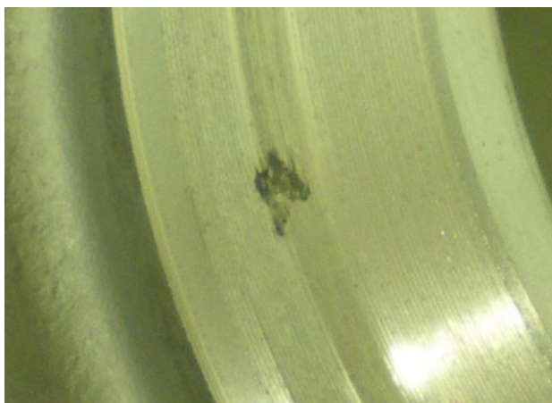
Obr. 49 Vměstky na obrobené ploše
