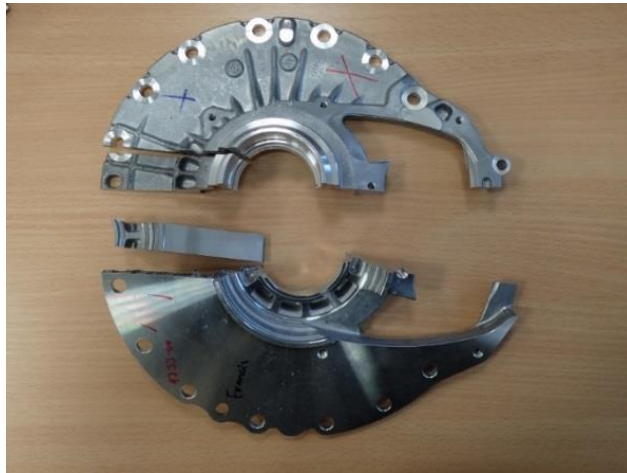
Obr. 53 Schéma odběru vzorků pro metalografii
