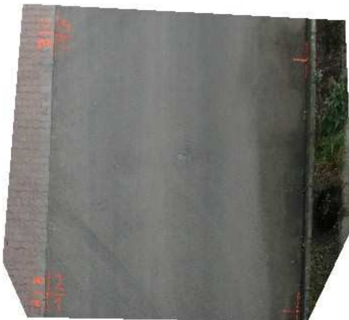
Obr. 12 V programu PC Rect vytvořený půdorysný pohled jednoho úseku (zdroj: Škoda-Auto a.s.)
