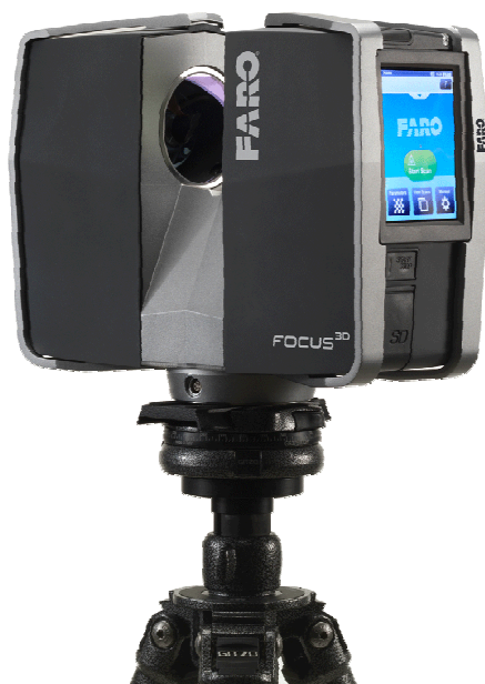
Obr. 17 Laserový skener FARO Focus 3D X130 (zdroj Škoda-Auto a.s.)
