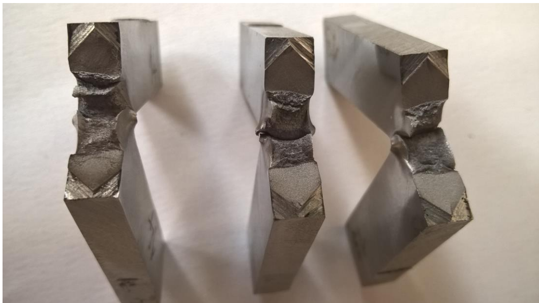
Obrázek 27: Snímek vzorků materiálu S355 po zatížení rázovým kladivem.
