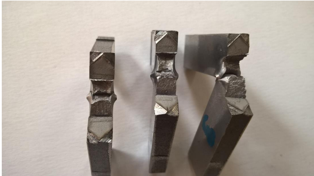
Obrázek 28: Snímek vzorků materiálu Domex 700MC po zatížení rázovým kladivem.
