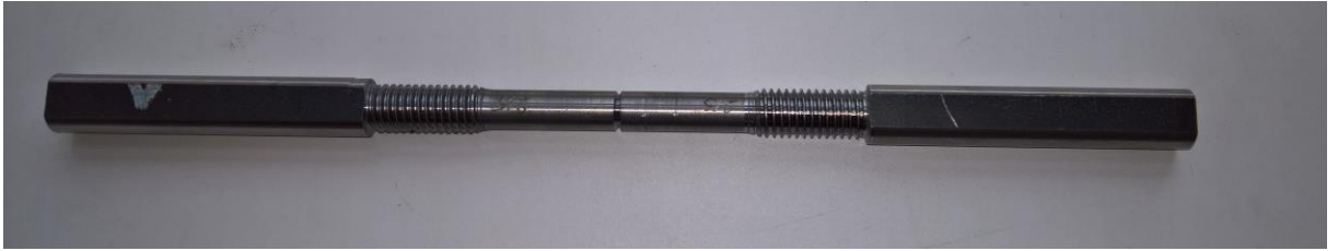
Obrázek 24: Reálná podoba kruhového vzorku z materiálu Domex 700MC.
