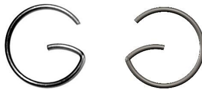
Obrázek č. 14 Vlevo skutečná pojistka, vpravo model pojistky pístního čepu
