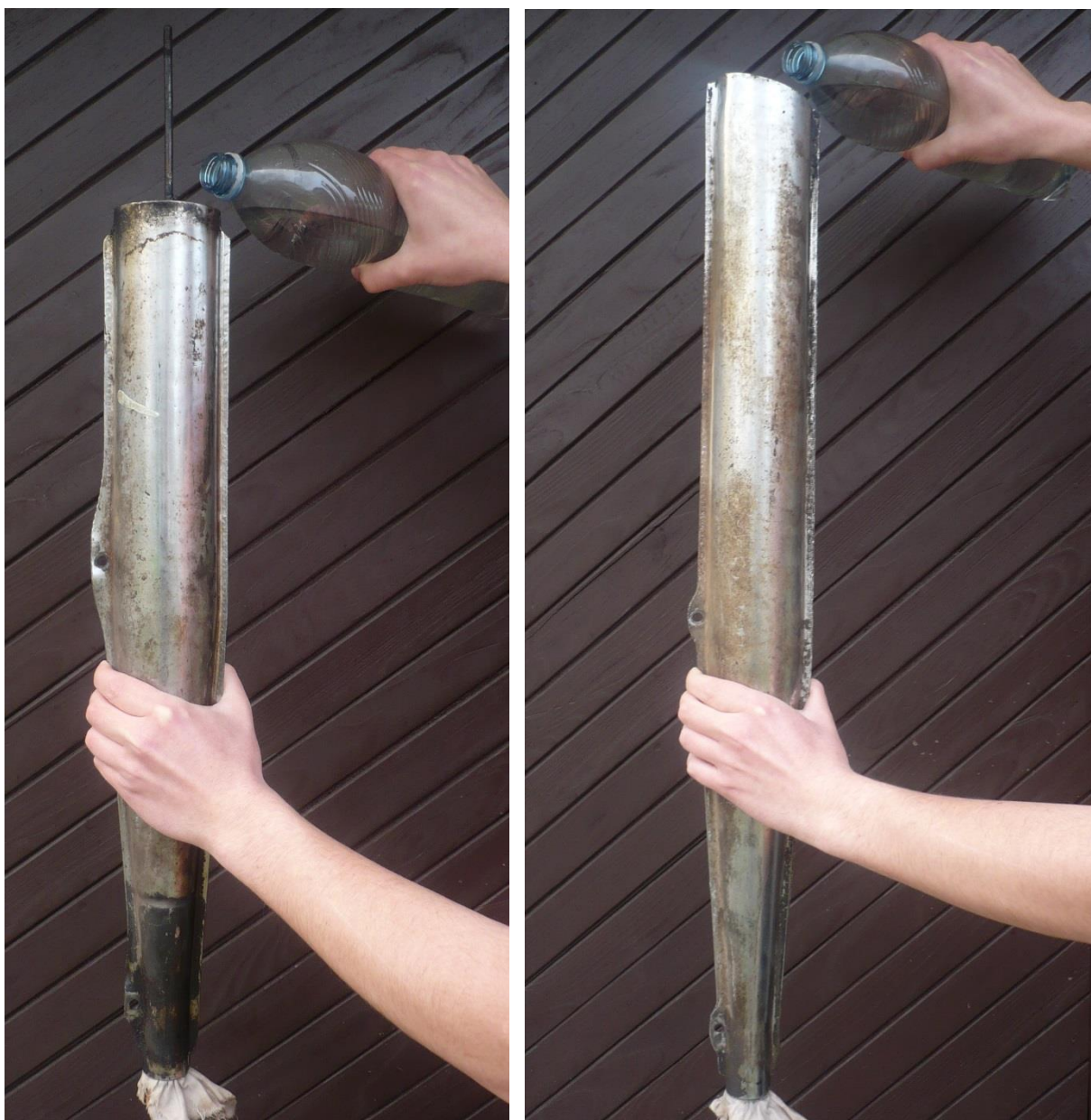
Příloha č. 10 Zjišťování objemu výfuku č. 1 (vlevo) a výfuku č. 2 (vpravo)
