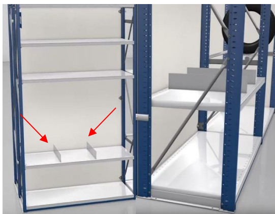
Obrázek 20 Vizualizace rozdělení policové regálové lokace (Nedcon, 2017)
