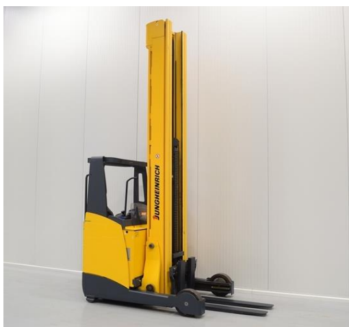
Obrázek 5 Vysokozdvížený vozík (TheTruckCompany, 2017)
