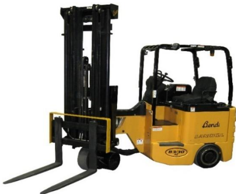
Obrázek 12 Elektrický čtyřcestný vysokozdvihový vozík Bendi B313 (bendi.co.uk, 2015)
