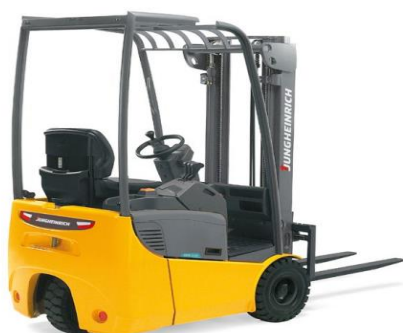
Obrázek 11 Elektrický vysokozdvížný vozík Jungheinrich 115 (jungheinrich.cz, 2016).
