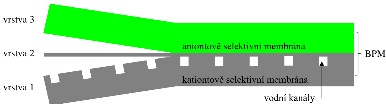
Obrázek 6: Bipolární membrána s vloženými vodními kanály v kationtově selektivní vrstvě 19
