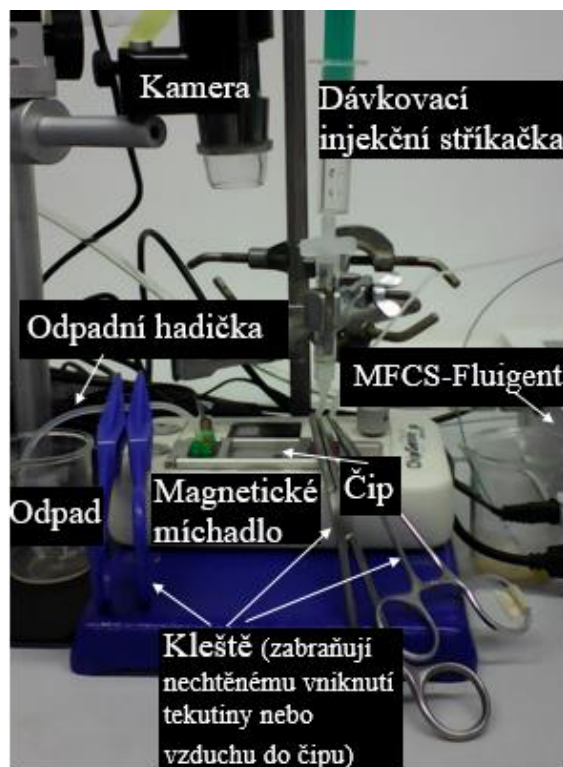
Obr. 49. Aparatura pro izolaci IgG v mikrofluidním uspořádání se zapojeným MFCS-Fluigent určeným k promývání magnetických částic umístěných v čipu
