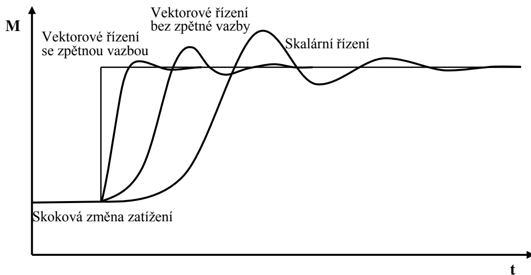
Obr. 25 – Reakce systému na skokovou změnu zatížení
