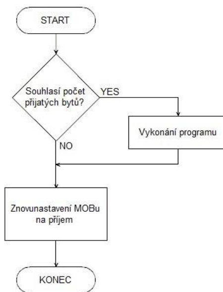
Obrázek 3.5 - Vývojový diagram reakce na přijatou CAN zprávu
