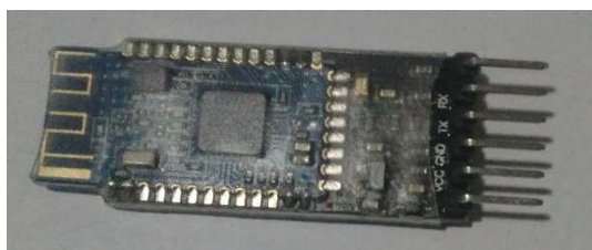
Obr. 7.2 – Bluetooth modul HM-10 se základní deskou
