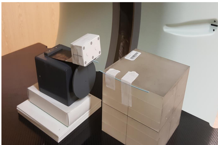
Obrázek 4 Fantom simulující dýchání se všemi ostatními částmi (autor ve spolupráci s vedoucím práce)
