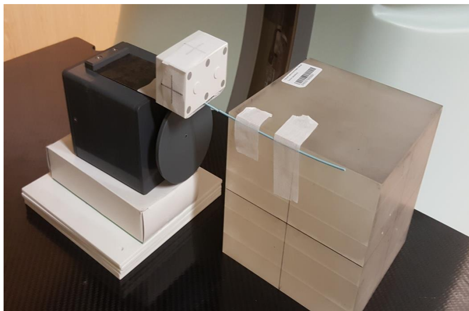
Obrázek 6 Připravený fantom pro kontrolu gating CT ve výdechu (autor ve spolupráci s vedoucím práce)
