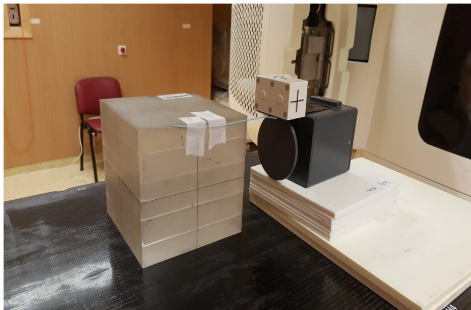
Obrázek 13 Připravený fantom pro kontrolu gating OBI ve výdechu (autor ve spolupráci s vedoucím práce)
