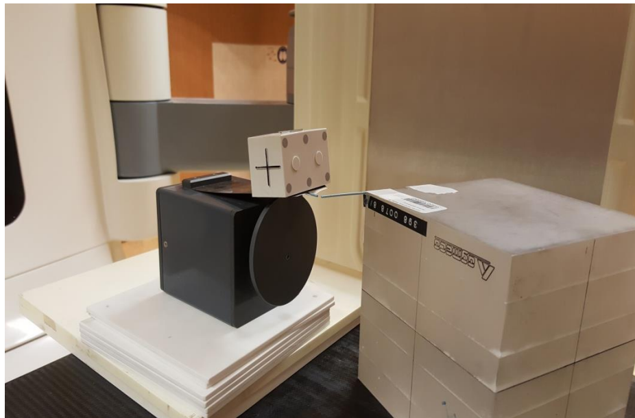
Obrázek 12 Připravený fantom pro kontrolu gating OBI v nádechu (autor ve spolupráci s vedoucím práce)
