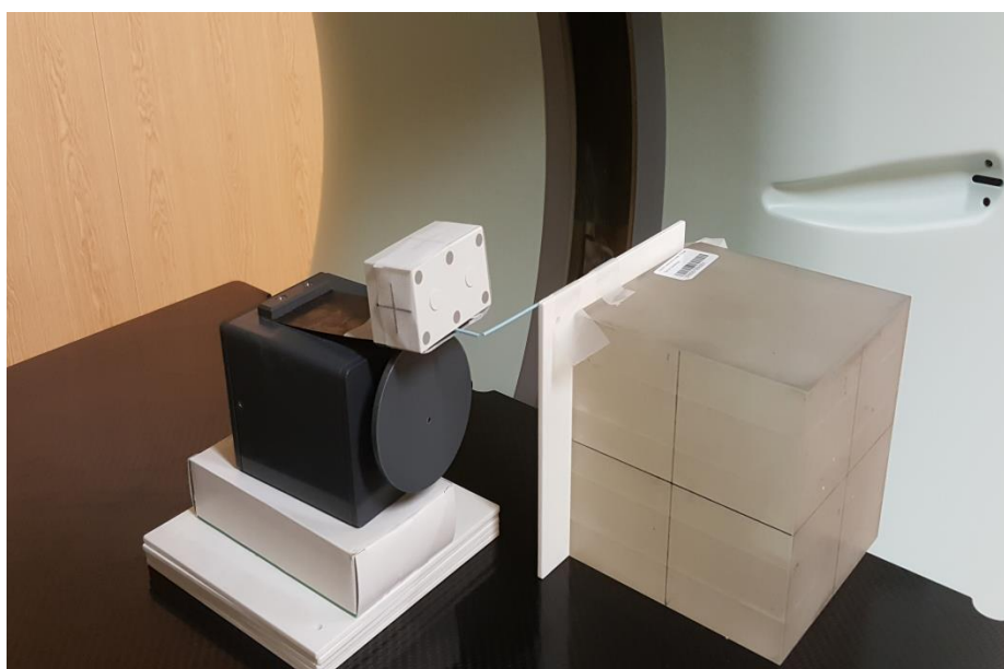
Obrázek 5 Připravený fantom pro kontrolu gating CT v nádechu (autor ve spolupráci s vedoucím práce)
