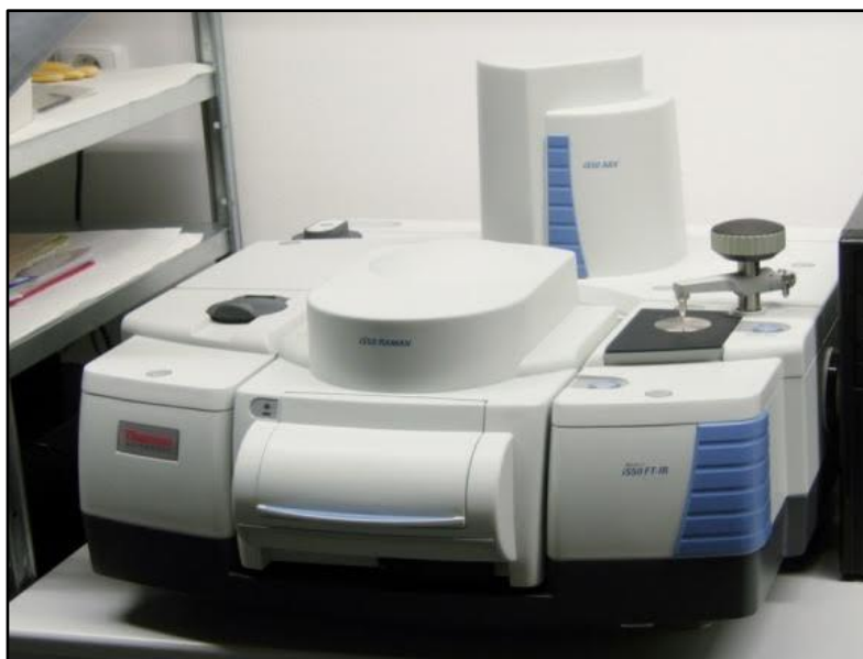
Obrázek 20 Přístroj FT-IR spektrometr Nicolet iS50 s vestavěným diamantovým ATR a FT-Ramanovým modulem
