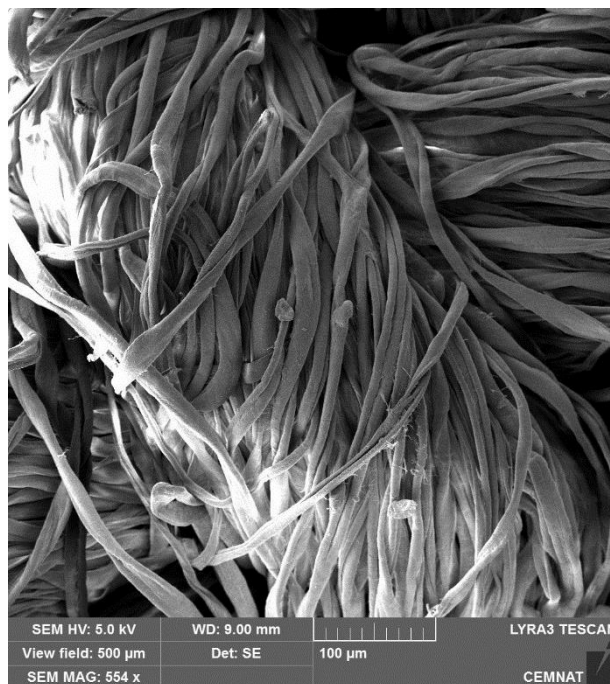
Obrázek č. 23: Snímek z REM povrchu bavlněné tkaniny prané v tvrdé vodě o 22 °dH s modelovým detergentem (patrona 13)
