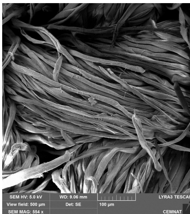
Obrázek č. 21: Snímek z REM povrchu bavlněné tkaniny prané v tvrdé vodě o 22 °dH s modelovým detergentem (patrona 11)
