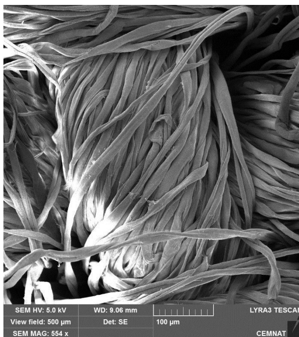
Obrázek č. 19: Snímek z REM povrchu bavlněné tkaniny prané v tvrdé vodě o 22 °dH s modelovým detergentem (patrona 9)
