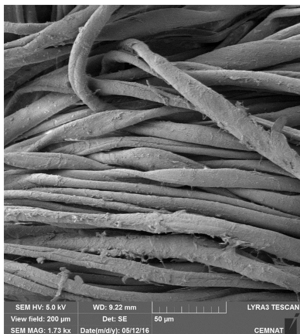
Obrázek č. 11: Snímek z REM povrchu bavlněné tkaniny prané v tvrdé vodě o 22 °dH s modelovým detergentem (patrona 1)
