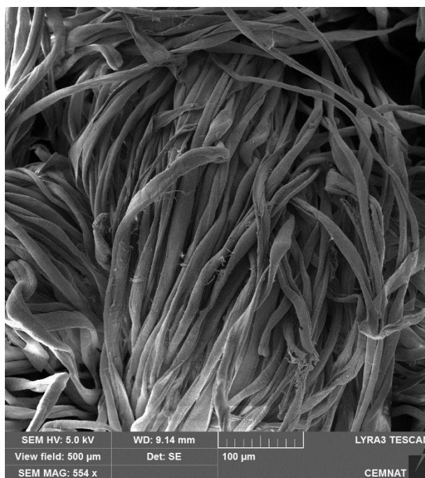
Obrázek č. 15: Snímek z REM povrchu bavlněné tkaniny prané v tvrdé vodě o 22 °dH s modelovým detergentem (patrona 5)
