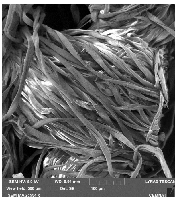
Obrázek č. 18: Snímek z REM povrchu bavlněné tkaniny prané v tvrdé vodě o 22 °dH s modelovým detergentem (patrona 8)
