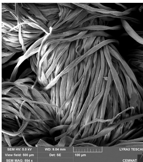
Obrázek č. 22: Snímek z REM povrchu bavlněné tkaniny prané v tvrdé vodě o 22 °dH s modelovým detergentem (patrona 12)
