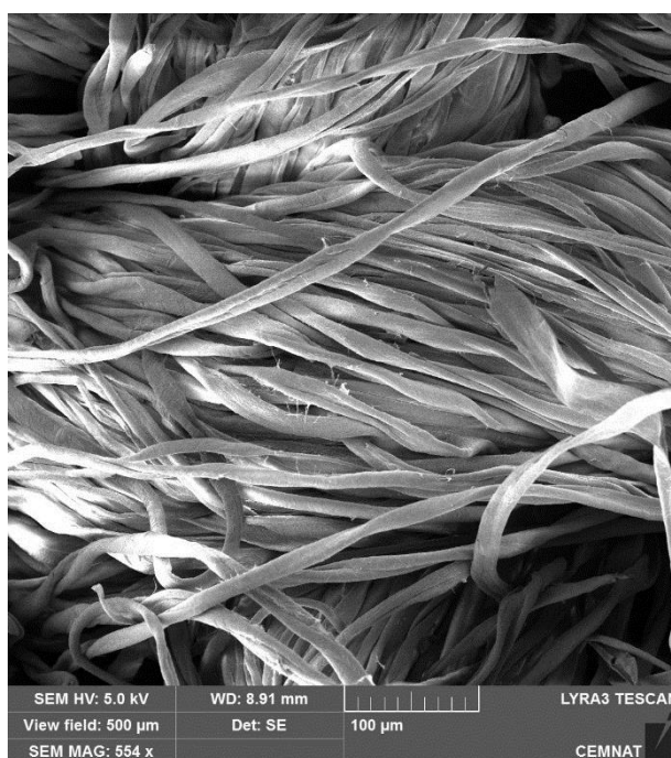
Obrázek č. 16: Snímek z REM povrchu bavlněné tkaniny prané v tvrdé vodě o 22 °dH s modelovým detergentem (patrona 6)
