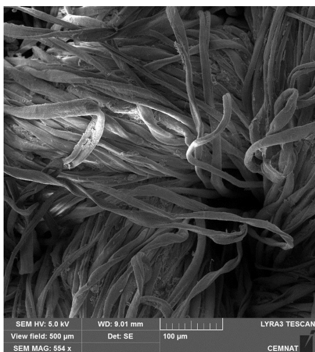
Obrázek č. 12: Snímek z REM povrchu bavlněné tkaniny prané v tvrdé vodě o 22 °dH s modelovým detergentem (patrona 2)
