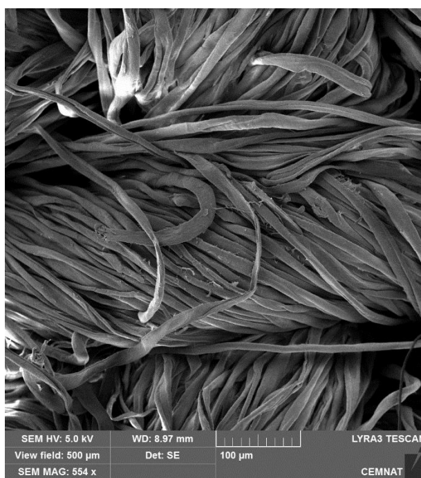
Obrázek č. 20: Snímek z REM povrchu bavlněné tkaniny prané v tvrdé vodě o 22 °dH s modelovým detergentem (patrona 10)
