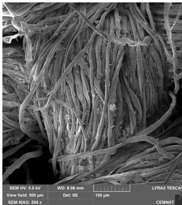
Obrázek č. 14: Snímek z REM povrchu bavlněné tkaniny prané v tvrdé vodě o 22 °dH s modelovým detergentem (patrona 4)
