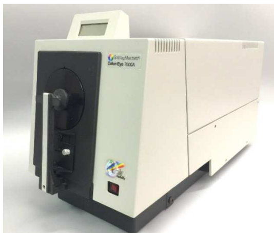
Obrázek 44 Spektrofotometr Macbeth Color Eye 7000A
