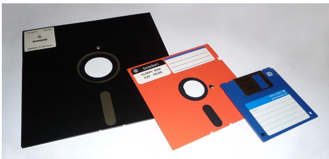
Obrázek 1.8 – Velikostní rozdíl disket 8", 5,25" a 3,5" (Disketa, 2016)
