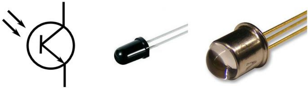
Obrázek 18 - Schématická značka a druhy provedení fototranzistorů
