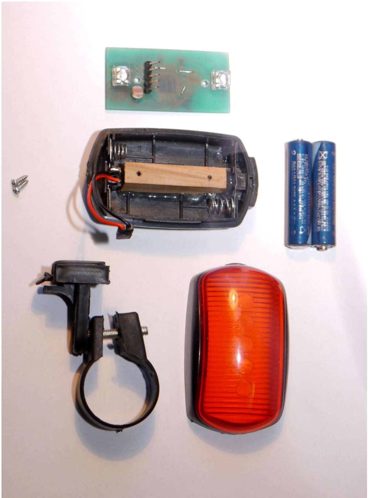
Rozložené brzdové světlo a všechny jeho součásti
