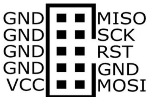
Obrázek 14 - ISP konektor KANDA 2x5 pinů (7)
