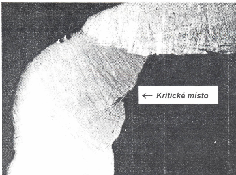
Obr. 13 Kritické místo u zakončení sousedících návarů (zv. 6.3x)
