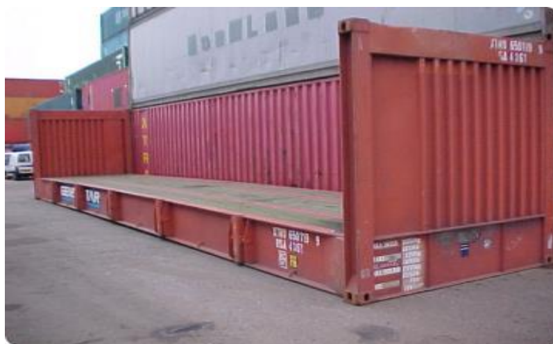
Obrázek 11: plošinový kontejner s pevnými čely
