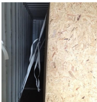
Obrázek 20: Příklad zajištění nákladu přivázáním
