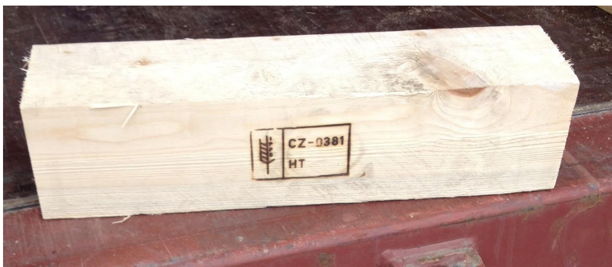
Obrázek 17: Značka fyto-sanitární ochrany detail
