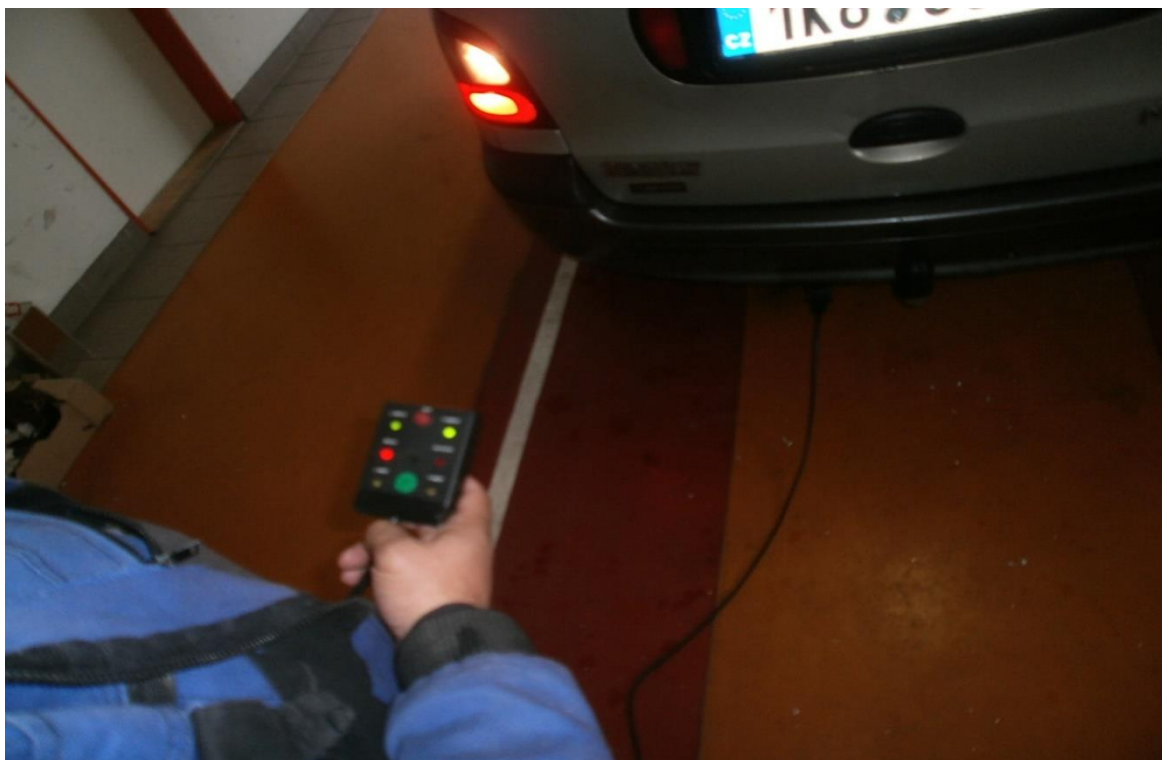
Obrázek č. 2: Kontrola funkčnosti elektrické zásuvky pro přívěsný vozík Zdroj: autor
