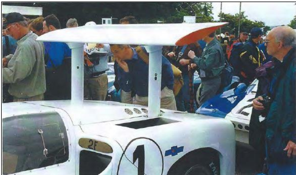
Obrázek 6: první přitlačné křídlo na vozu Chaparral 2F [6]
