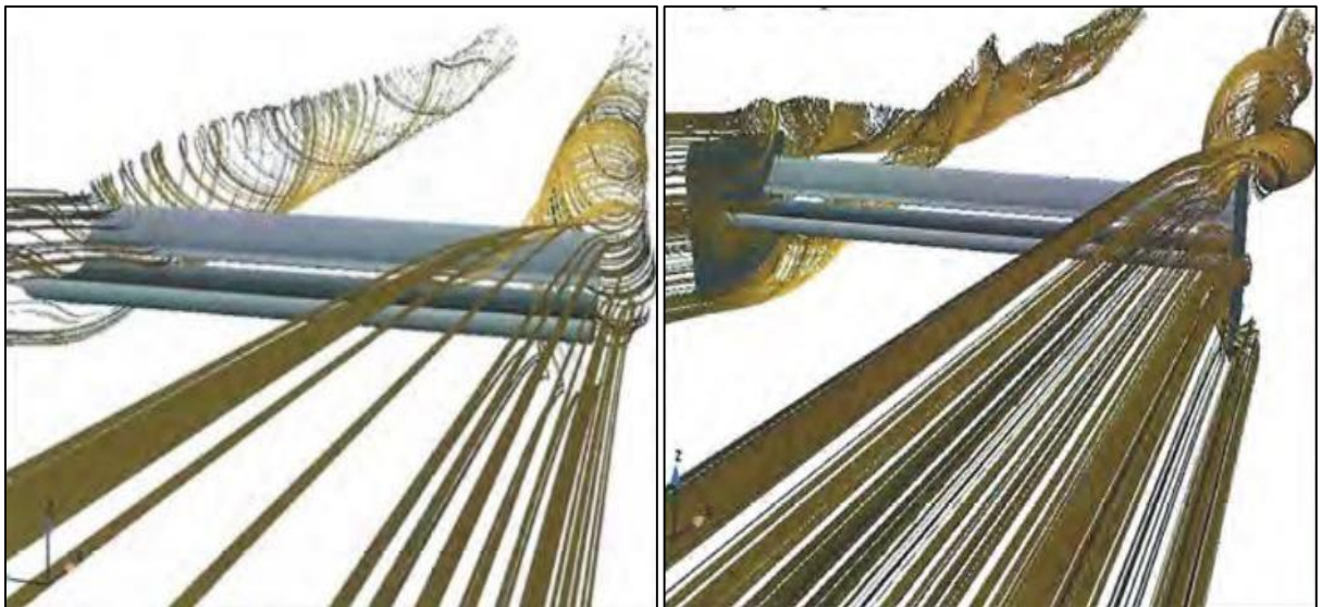
Obrázek 18: Vzdušné víry za křídlem bez bočních desek [9]
