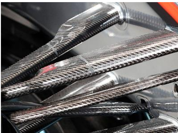
Obrázek 20: Zavěšení předního kola vozu F1 značky Lotus z uhlíkového kompozitu [17]
