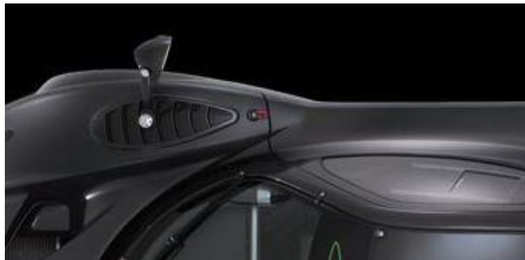
Obrázek 5: vyústění bočních kanálů nad kolem [16]
