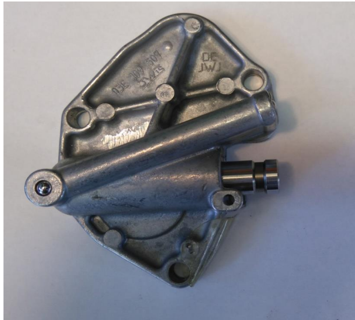
Obrázek 20 Krajní poloha napínače rozvodového mechanismu po úpravě
