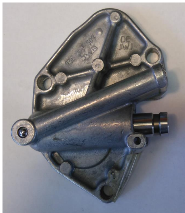
Příloha J Krajní poloha modifikovaného napínače
