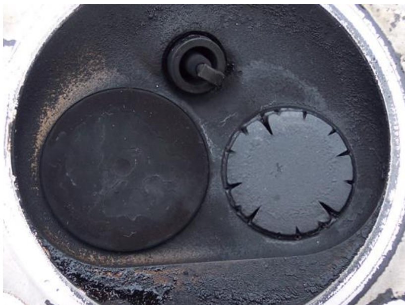
Obrázek 18 Popraskaný ventil v detailním pohledu [22]
