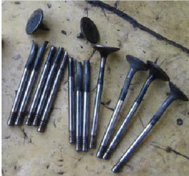
Obrázek 19 Poškozené ventily po přeskočení rozvodů [23]
