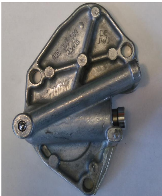
Příloha I Krajní poloha sériového napínače
